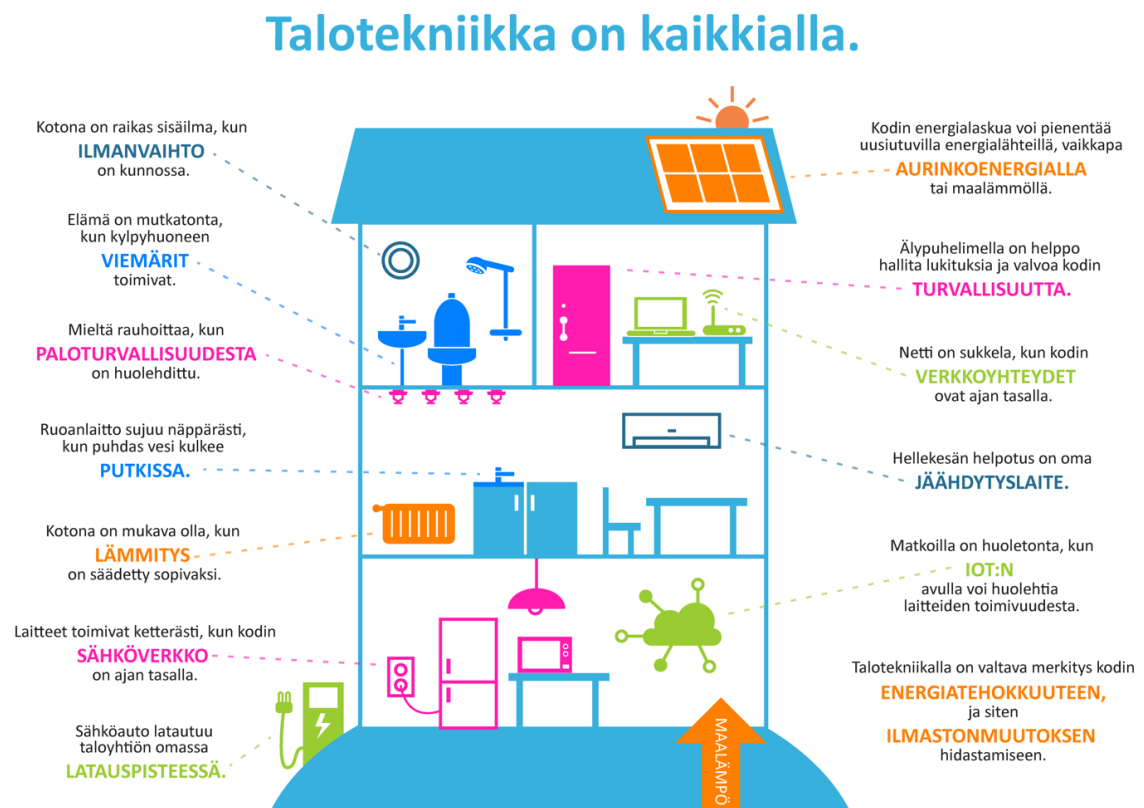
Kuva 5. Esimerkki rakennuksesta löytyvästä talotekniikasta [21].
