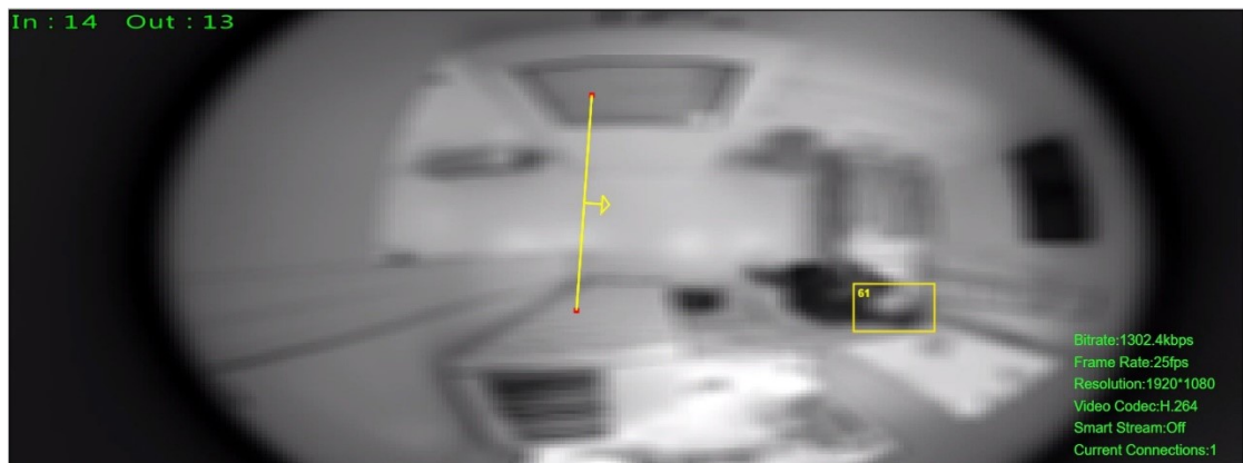
Kuva 14. Linjalaskennan testausta potilashuoneessa
