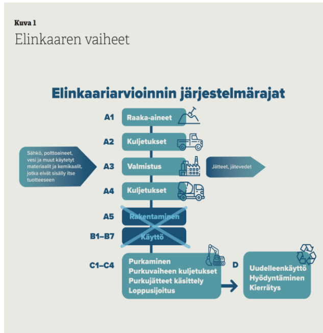
Kuva 5. Elinkaariarvioinnin järjestelmäraajat (Vahanen Environment Oy 2021) Laskelmien perusteella C30/37 normaalisti kovettuvan rakennebetonin valmistuksessa sementin hallitsevan osan hiilidioksidipäästöistä jälkeen sijoittuu kuljetukset koko elinkaaren aikana, 20 % osuudella. Kuljetusten osuus hiilidioksidipäästöistä on vähintäänkin merkittävä ja näissä laskelmissa on huomioitu tyhjät paluukuormat. (Suomalaisen betonin hiilijalanjälki 2021, 89.)
