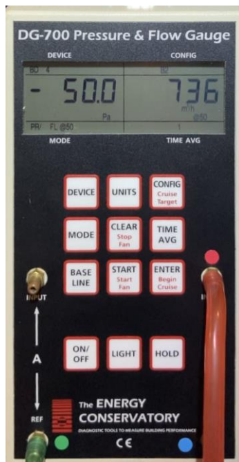
Kuva 13. Kohteen vuotoilmamäärä 50 Pa alipaineessa.
