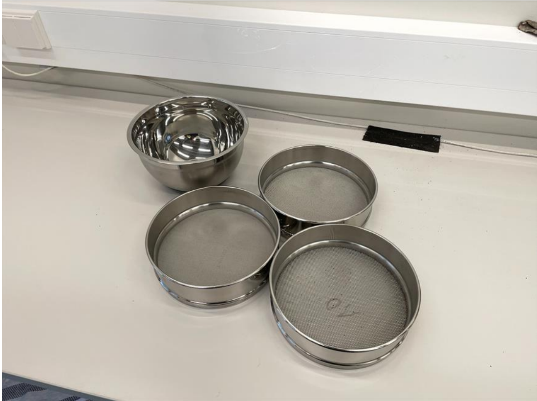
Kuva 13. Seulaverkot kokoa 0,3 mm, 0,5 mm ja 1,0 mm, astiaan jää alite.
