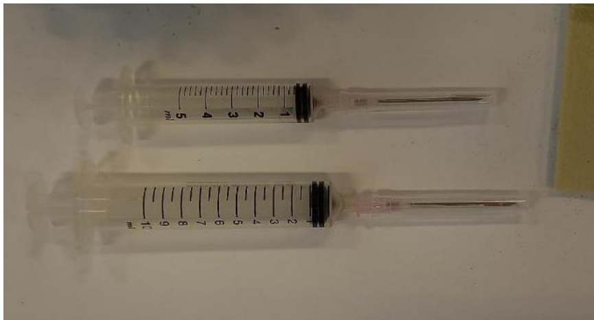
Kuva 67. Rakenteen konsolidoinnissa käytettävät ruiskut (2024)
