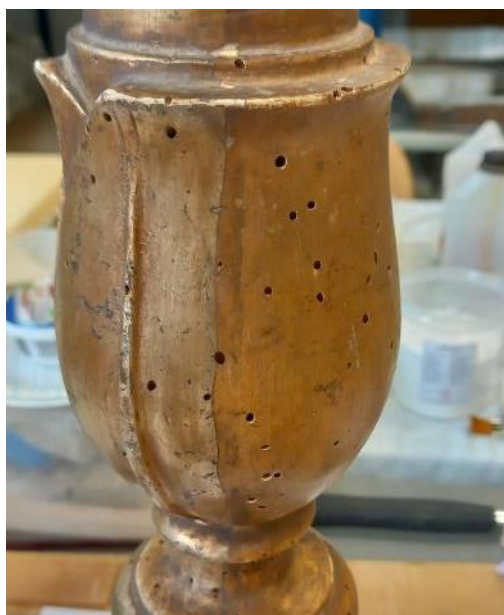
Kuva 49. Tupajumin lentoaukkoja kynttilänjalassa (2024)
