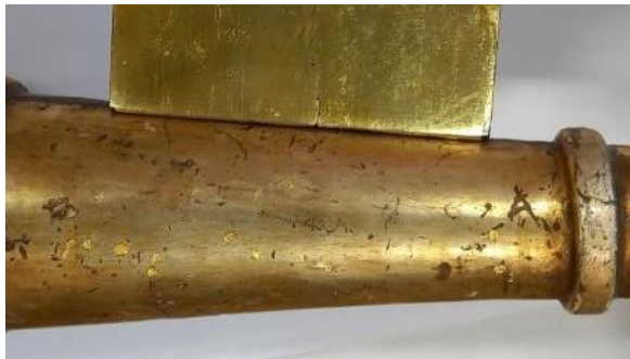
Kuva 82. Meccatura-lakkanäyte verrattuna kynttilänjalan omaan lakkaan (2024)
