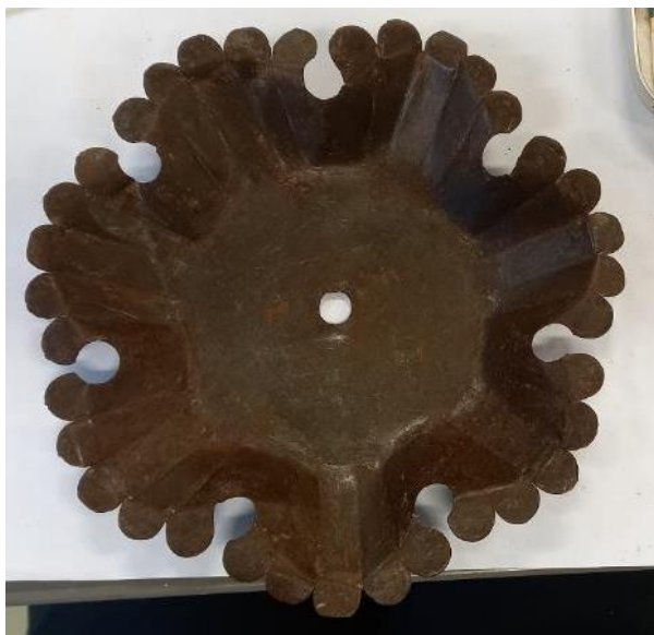
Kuva 89. Kynttilälautanen mekaanisen ruosteenpoiston jälkeen (2024)
