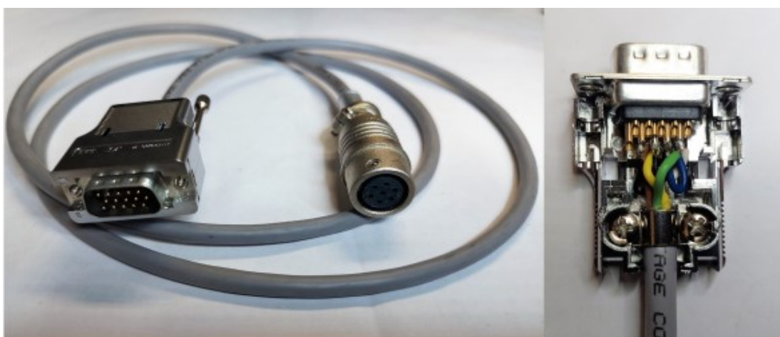
Kuva 18. Valmis SUBHD15-PRC03-adapteri ja johtimien juotokset.
