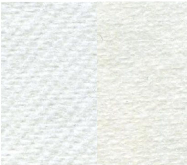
KUVA 23. Päälystämätön ja koepisteen 4 päälystetty kuitukangas (Kuva: Kir-sikka Nordström 2024).
