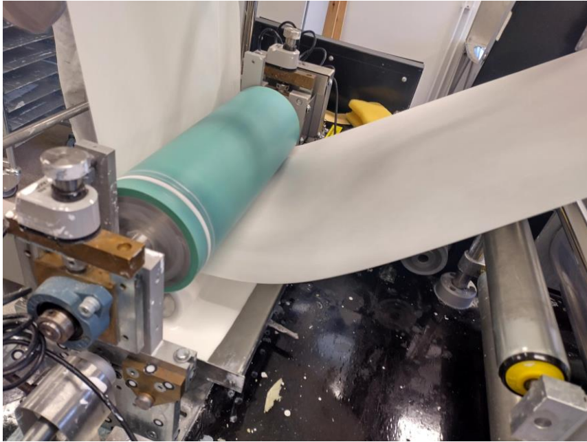
KUVA 19. Päällysteen kertyminen oikeaan reunaan koeajossa 5 päällystepastalla, jossa 65 % AKD:tä ja 35 % CMC:tä kuiva-ainepitoisuuden ollessa 16,63 % (Kuva: Kirsikka Nordström 2024).
