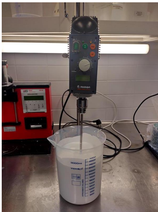
KUVA 5. Valmis päällystyspasta (Kuva: Kirsikka Nordström 2024).
