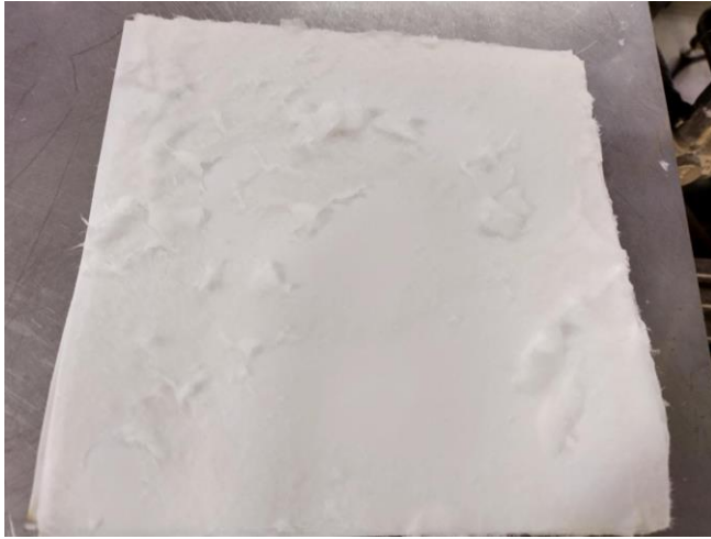
KUVA 15. Epäonnistunut arkki imupaperin päällä viiralta poiston jälkeen (Kuva: Kirsikka Nordström 2024).
