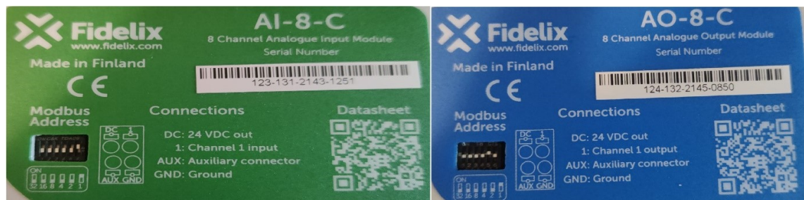
Kuva 19. Moduulien fyysinen osoitteistaminen.
