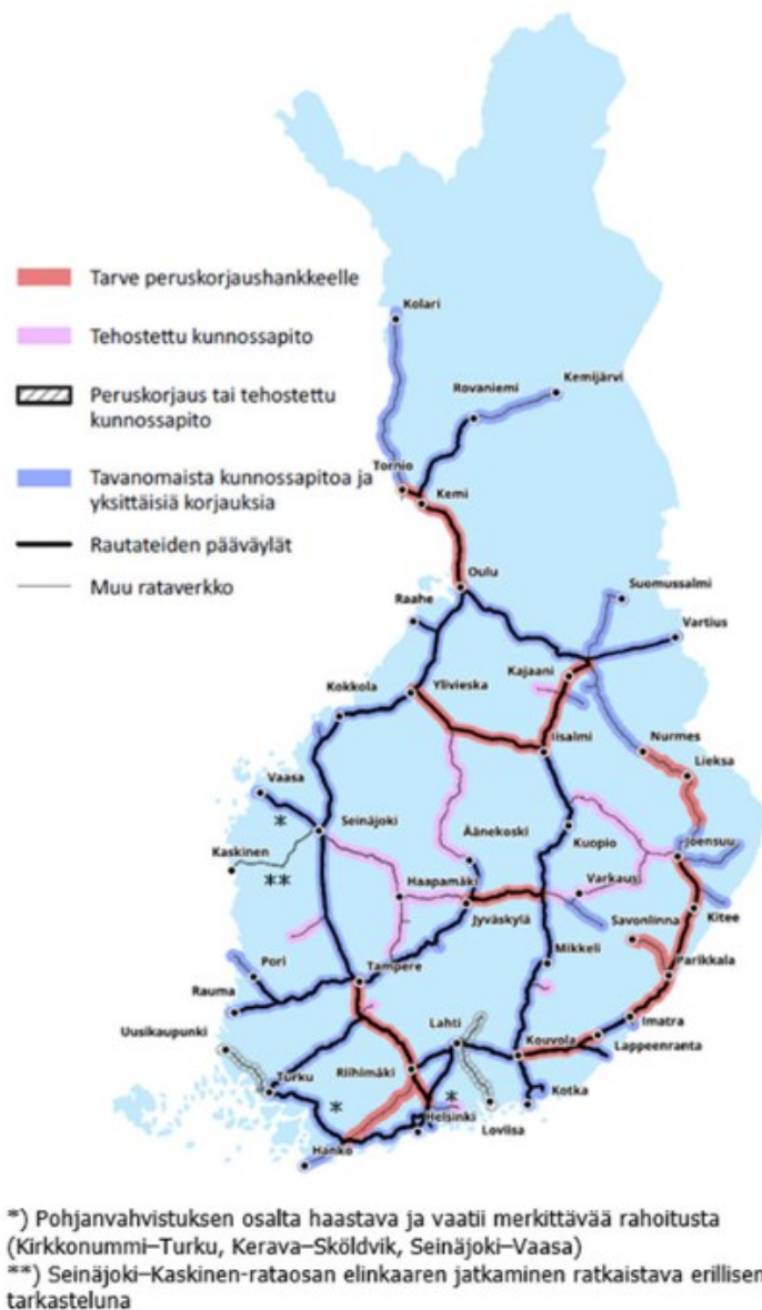
KUVA 1 Rataverkon päällysrakenteen korjaustarve vuonna 2023 (Traficom 2023)
