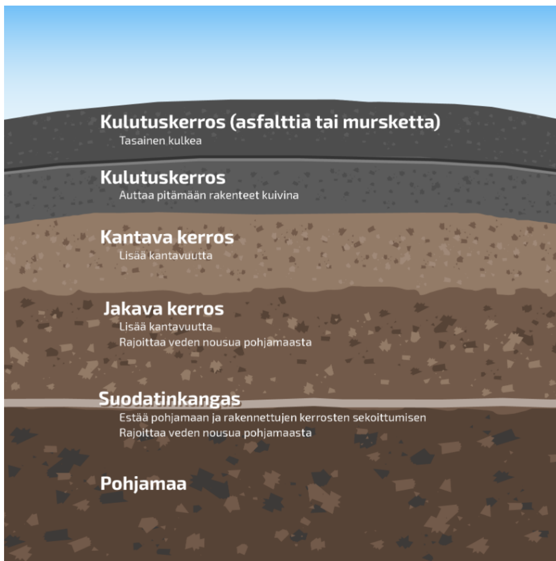
KUVA 10. Tien rakennekerrokset (Väylävirasto 2020)
