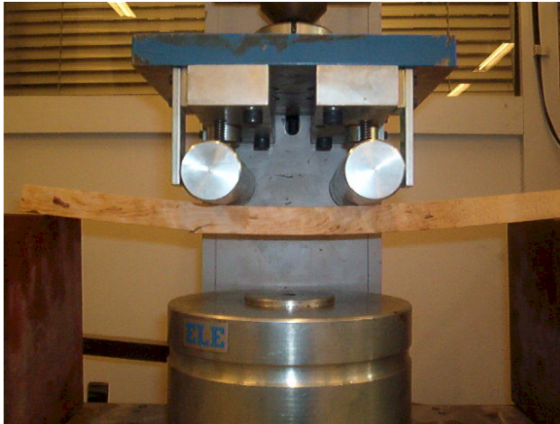
Kuva 1. Nelipistetaitutuksen koeasettelu, jossa taivutuslujuuskoekappale on murtumassa
