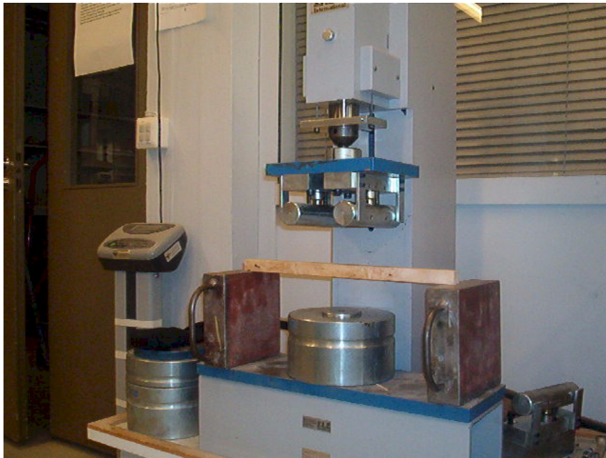
Kuva 7. Taivutuskoejärjestely rakennetutkimuslaboratoriossa. Painimena käytettiin laboratorion taivutuspaininta, jonka kuormituspisteiden keskikobtien väliseksi etäisyydeksi mitattiin 105 mm. Kuormituspisteen ja tuen etureunan välinen etäisyys oli 127,5 mm.
