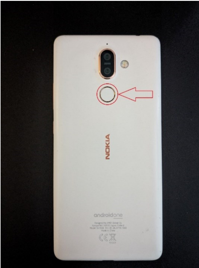
Kuva 4. Kapasitiivinen sormenjälkitunnistin älypuhelimien takaosassa
