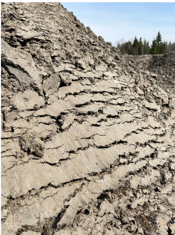
Kuva 3. Silttiä läjitettynä työmaalla.
