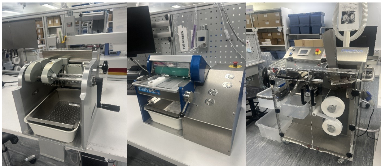
Kuva 9. Manuaalinen, puoliautomaattinen ja automaattinen purkulaite
