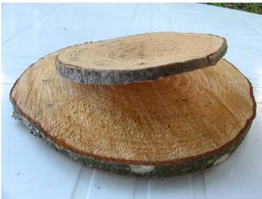
Kuva 1. Kuivuessaan käyrystyneet ohuet leppäkietot
