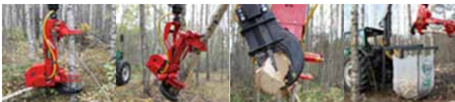
Kuva 3. Halkaisukiilalla varustettu sykeharvesteri toiminnassa
