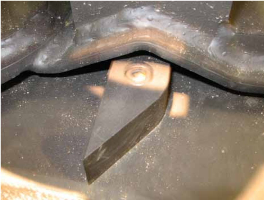
Kuva 2. Pentin Paja Oy:n Naarva S23 -sykeharvesterin giljotiini sekä klapien halkaisukiila
