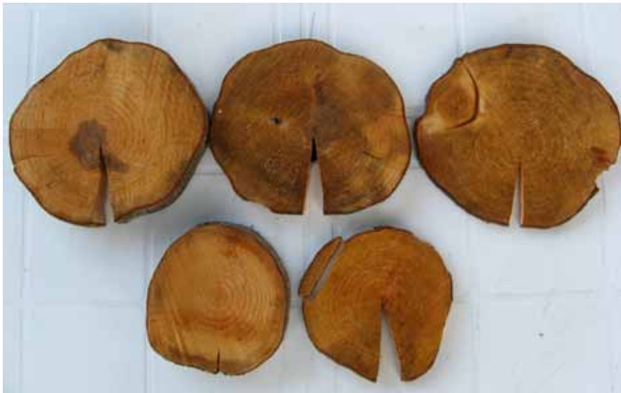
Kuva 2. Kuivuksessa halkeilleet ohuet leppäkiekot
