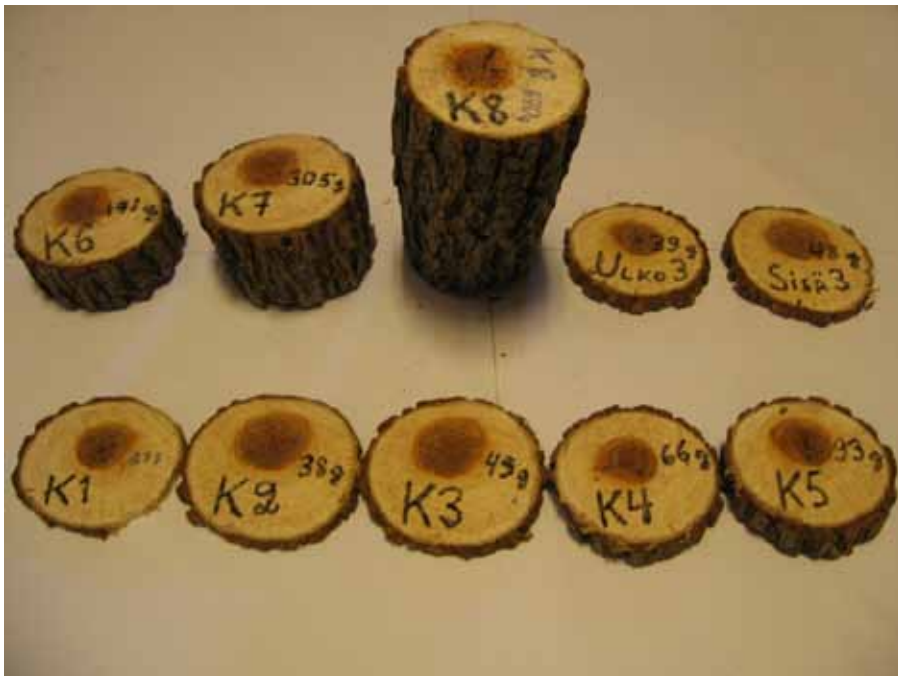
Kuva 3. Terijoensalavan kiekot ja rullat sisällä ja ulkona kuivatus lokakuu 2014
