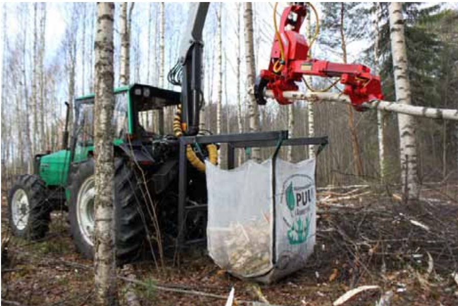
Kuva 1. Klapien suora suursäkitys Naarva S23 sykeharvesterilla (Naarva 2014c)
