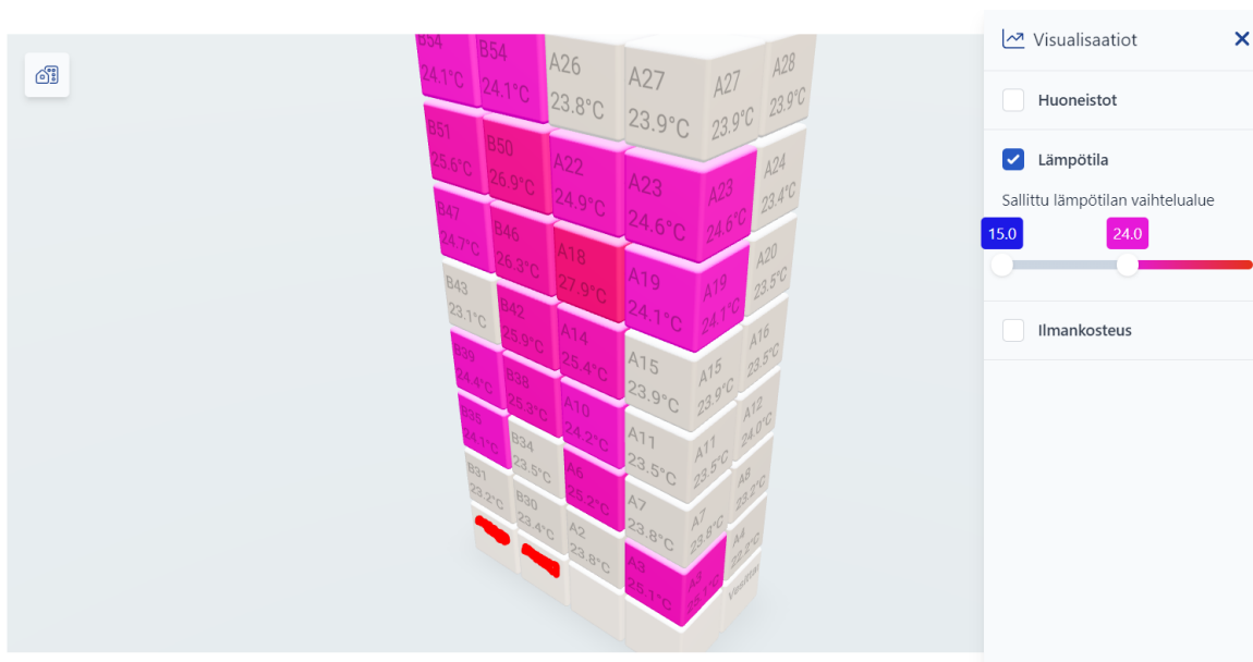
Kuva 7. myMetec-palvelussa voidaan tarkastella kiinteistöjen lämpötilaprofiileja 3D:nä
