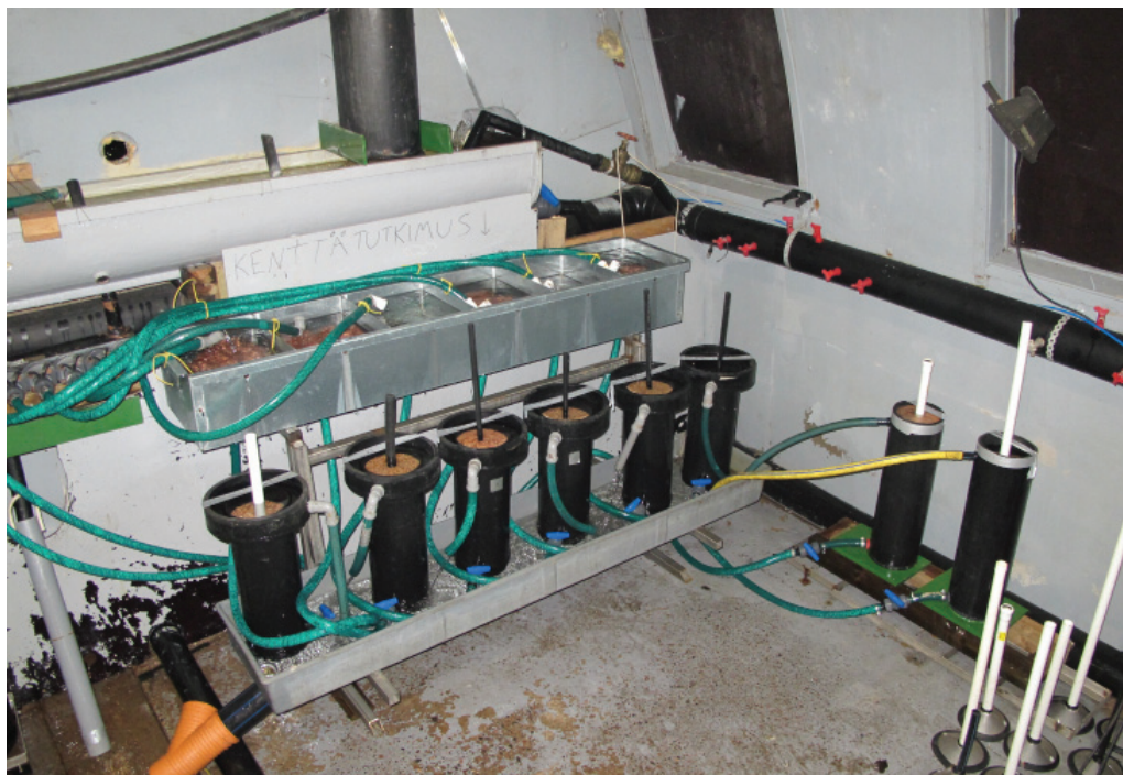
KUVA 2. Kuparikuitukaukalo, jossa on kuusi erillistä allasta kuparivilloille sekä kaksi kontrollisaavia, joihin vesi tulee suoraan tulovedestä ilman kuparikäsittelyä. Kuva: Raisa Kääriä.
