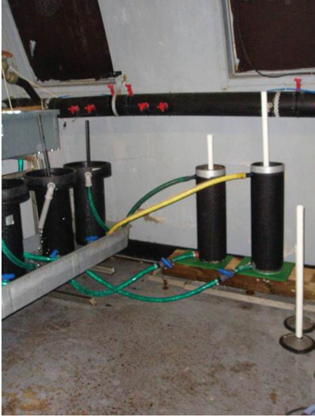
KUVA 5. Kaksi kontrolliyksikköä, joihin ei johdettu kupari-ionisoitua vettä. Kuva: Sami Skyttä.
