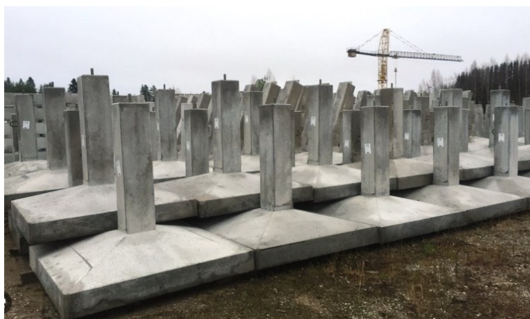
Kuva 1. Pilariperustuselementit (Rudus, i.a.).
