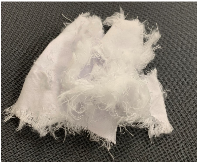
Kuva 9. Kuitu giljotiinileikkuun jälkeen (Kuva: Teri Niekka).
