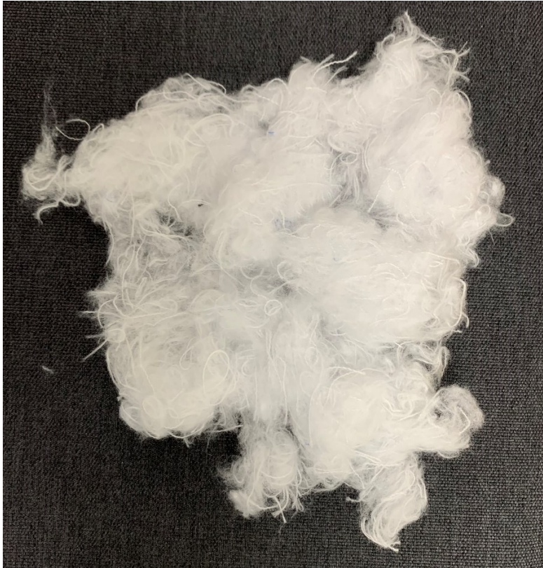
Kuva 10. Mekaanisessa kuidunavausprosessissa avattua kuitua (Kuva: Teri Niekka).
