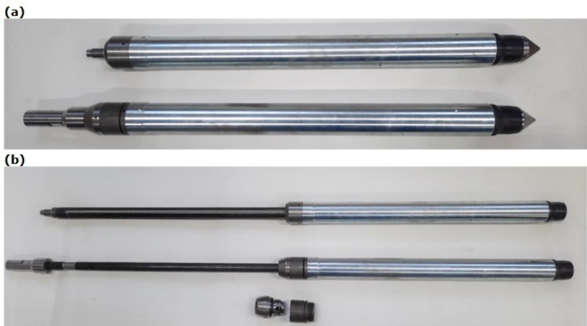
Kuva 3. STI-näytteenottimia: (a) mäntä kiinni: uralukitusmalli (yllä) ja kuulalukitusmalli (alla) ja (b) mäntä auki: uralukitusmalli (yllä) ja kuulalukitusmalli sekä kuulalukitusmekanismi purettuna (alla). /2/
