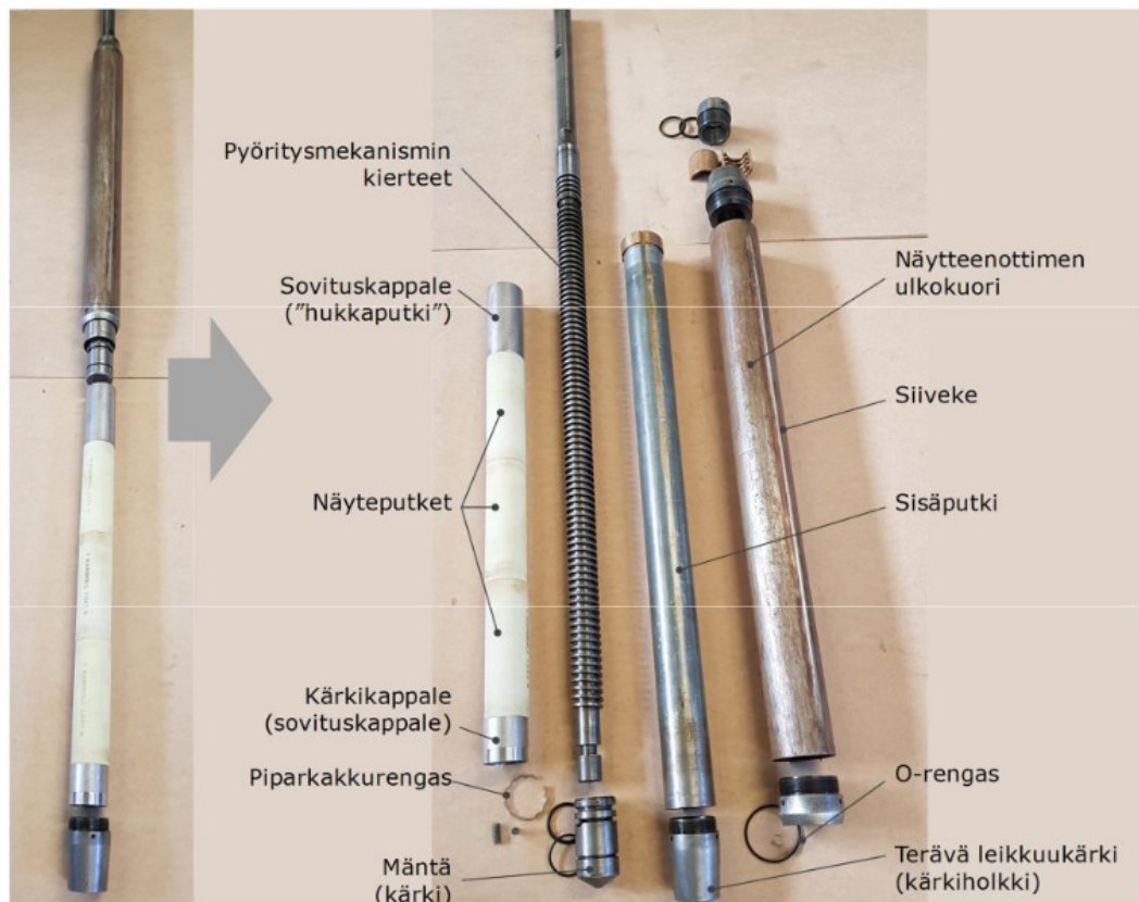
Kuva 2. STII-näytteenotin osittain koottuna (vasemmalla) ja otin purettuna. Näyteputket ovat 170 mm pitkiä ja sisähalkaisijaltaan 50 mm. /1/
