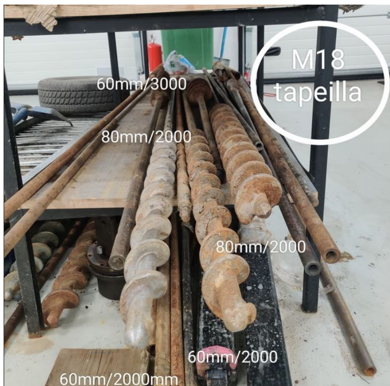
Kuva 6. Erikokoisia kierrekairoja GM 50 -geotekniseen kairavaunuun.
