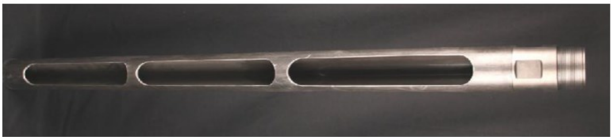
Kuva 14. Ikkunaotin tien rakennekerros tutkimuksiin. /4/
