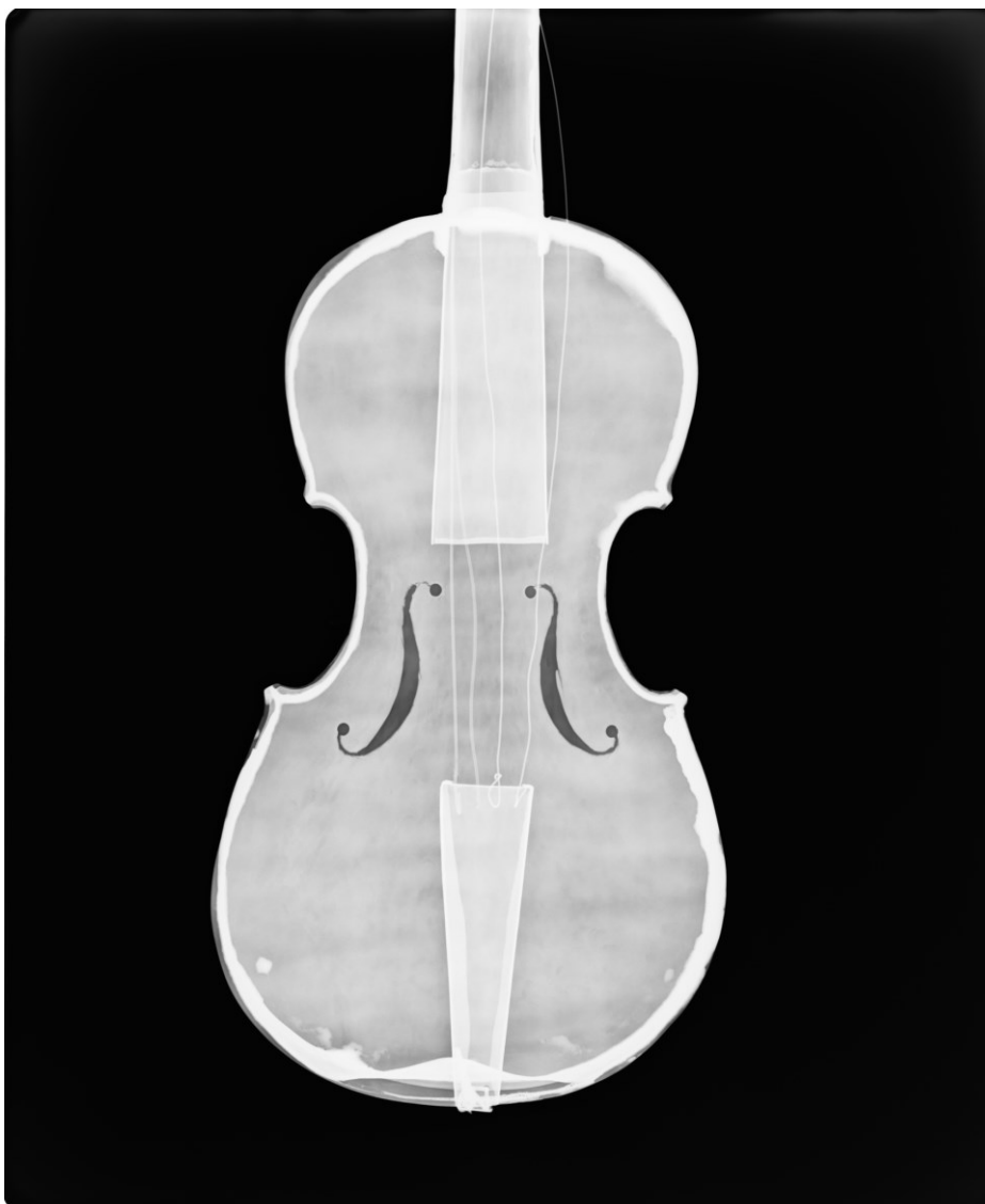
Kuva 5. Röntgenkuva viulun kaikukopasta, kuvantamisessa käytetty jännite 70 kV ja virta 4,0 mAs (Juuti 2004).
