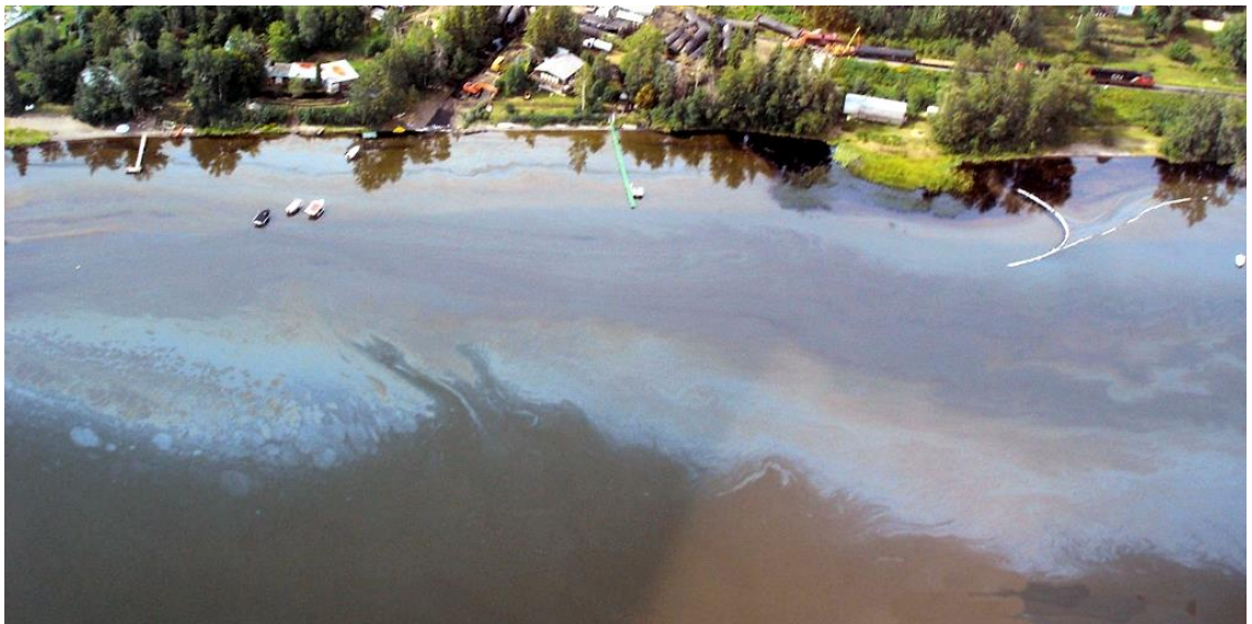
Kuva 6. Virran tai tuulen levittämä öljylautta (Fingas 2013, 62).
