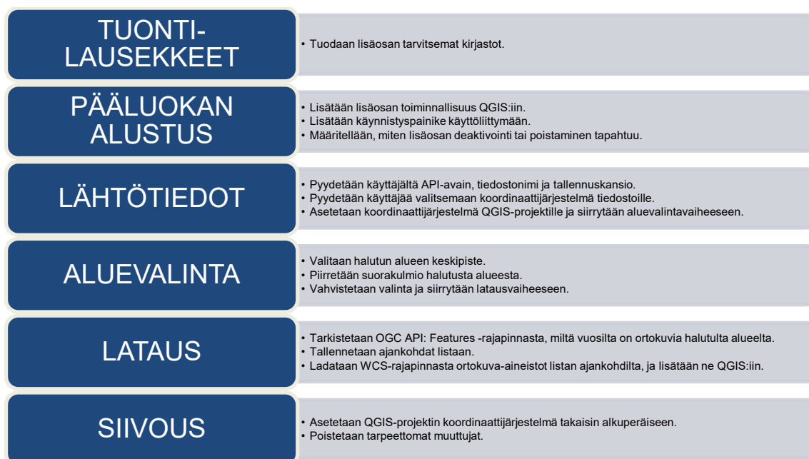
Kuva 8. Toteutetun lisäosan rakenne sekä vaiheiden tehtävät.
