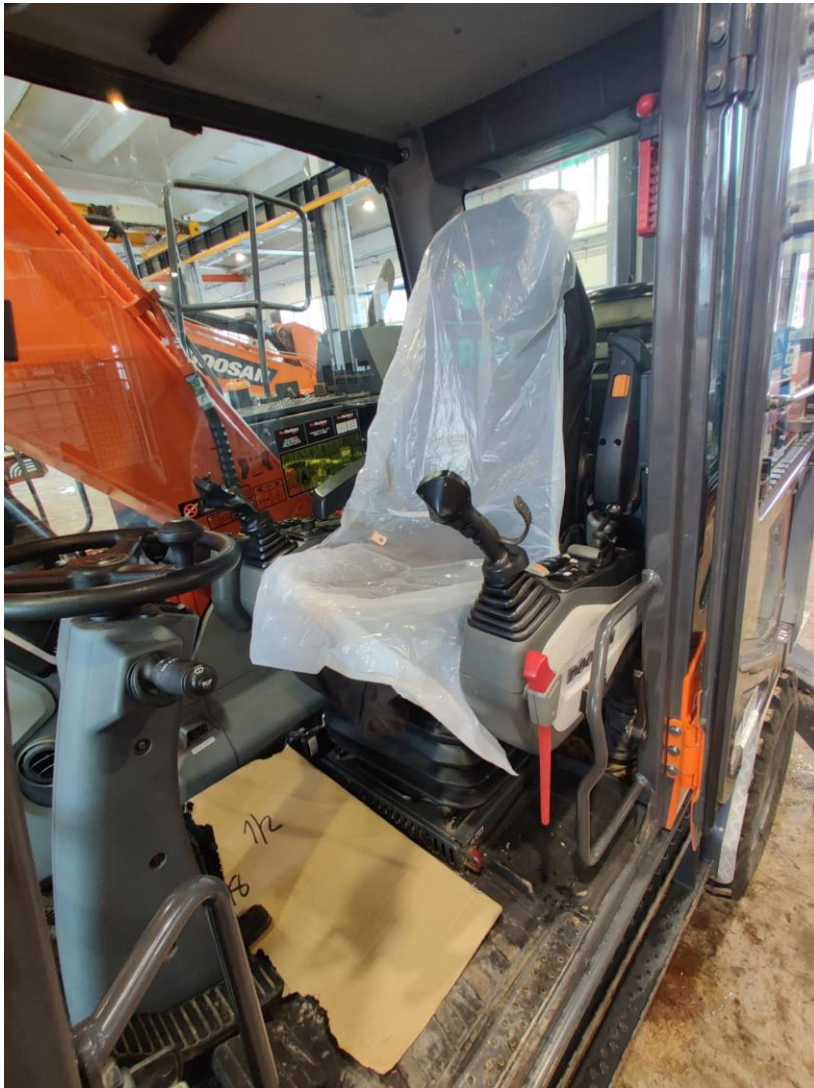
Kuva 19. Koneiden hyttien suojaus.
