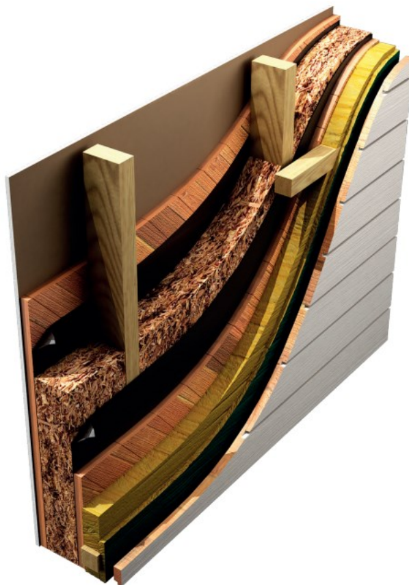
KUVA 3. Lisälämmöneristetty seinärakenne (Nieminen & Virta 2016, 19)
