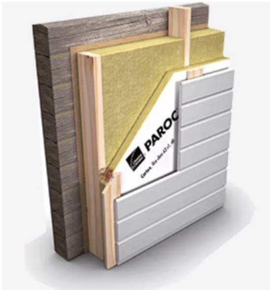
KUVA 4. Hirsirakenteen ulkopuolinen eristys (Paroc, n.d.)
