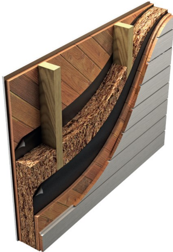
KUVA 2. Yleinen purueristeinen seinärakenne (Nieminen & Virta 2016, 19)
