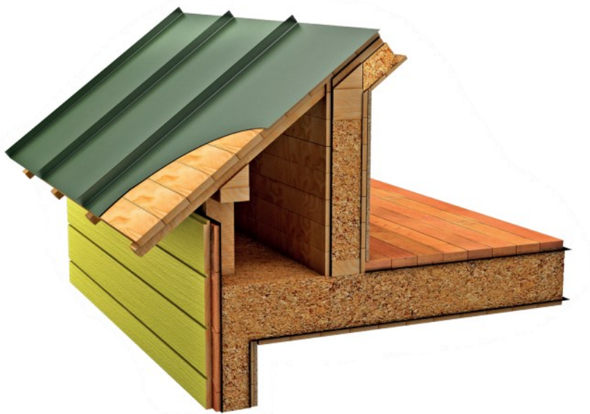
KUVA 5. Vesikatteen suuntainen eristys (Nieminen & Virta 2016, 24)
