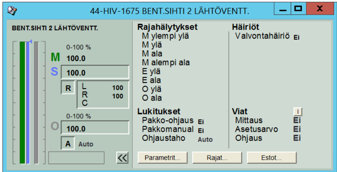
Kuva 26. Bentoniittisihdin 2 lähtöventtiin 44-HIV-1675 piiri-ikkuna (Hirvonen 2023)
