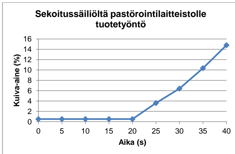
Kuvio 1. Sekoitussäiliöltä pastörintilaitteistolle kulkevan linjan tuotetyönnöstä otettujen näytteiden kuiva-ainepitoisuudet työnnön aikana.
