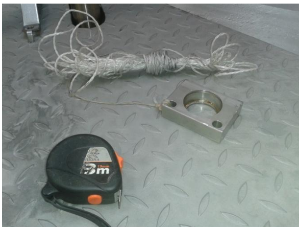
Kuva 6. Säiliöön jäävän tuotemäärän mittauksessa käytetyt välineet.
