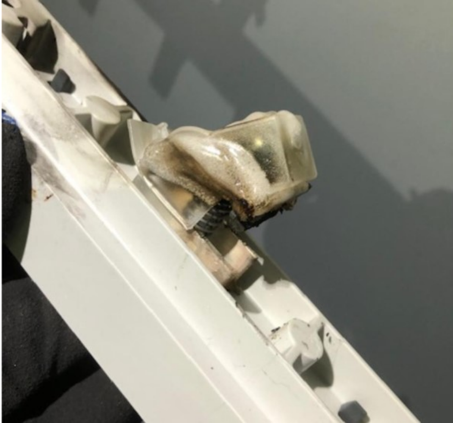
Kuvio 39. Kuviossa ABB:n XLBM -tyypin jonovarokeytkin, missä sulanut liitinsuoja
