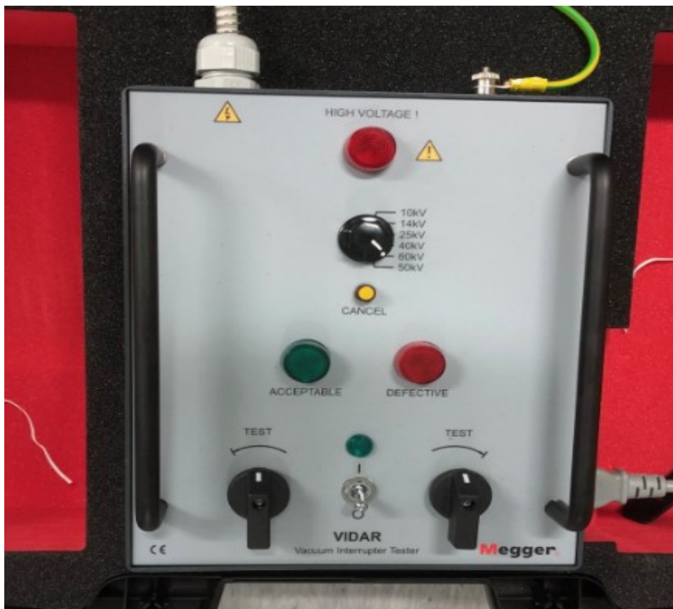
Kuvio 27. Meggerin valmistama tyhjiötiivestesteri mallia Vidar
