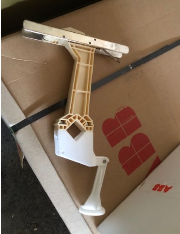
Kuvio 35. Uusi varaosa kytkentä kärjellä ja puhallus sylinterillä erottimeen OJDO 24 A3
