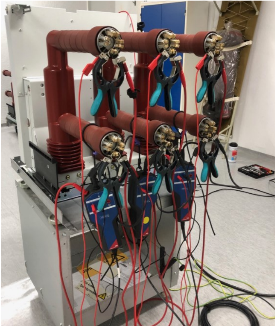
Kuvio 26. Omicron Cibano 500 -mittajohtimet kytkettynä ylijännitteenmittausta varten
