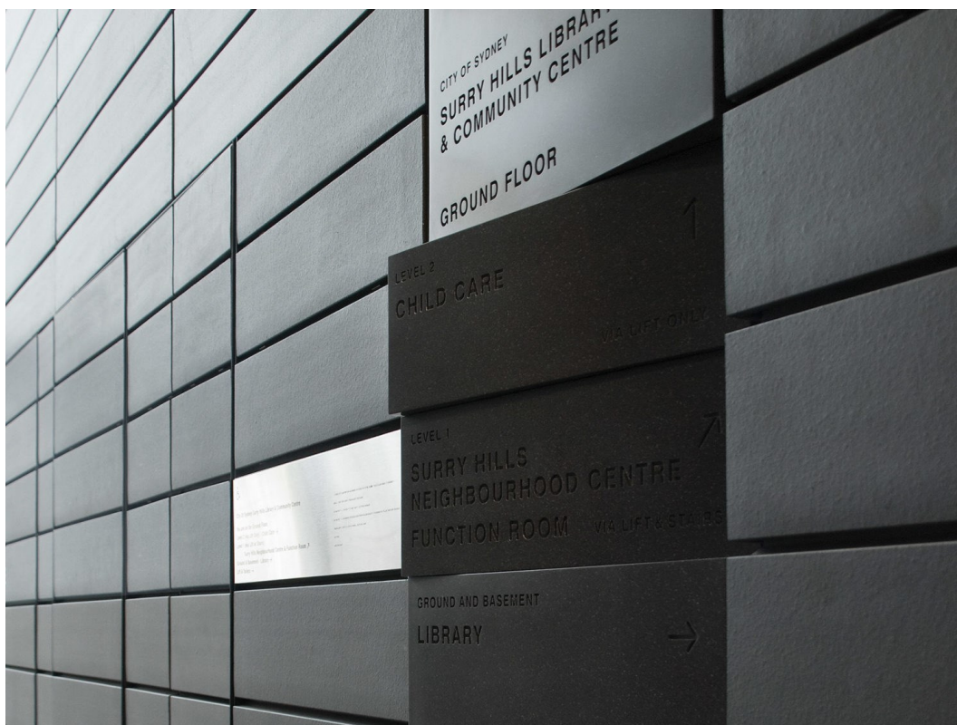
Kuva 3. Valo luo kontrastin Surry Hillsin kirjaston ja monitoimitalon opasteisiin, joten vääränlainen valo voi merkittävästi huonontaa luettavuutta (Collider i.a.).
