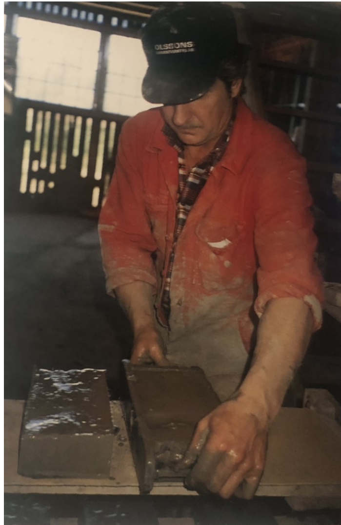
KUVA 7. Savitiilen käsin valantaa. (Sandstöm&Johansson 2007: Hantverket i gamla hus 2007, 37.)
