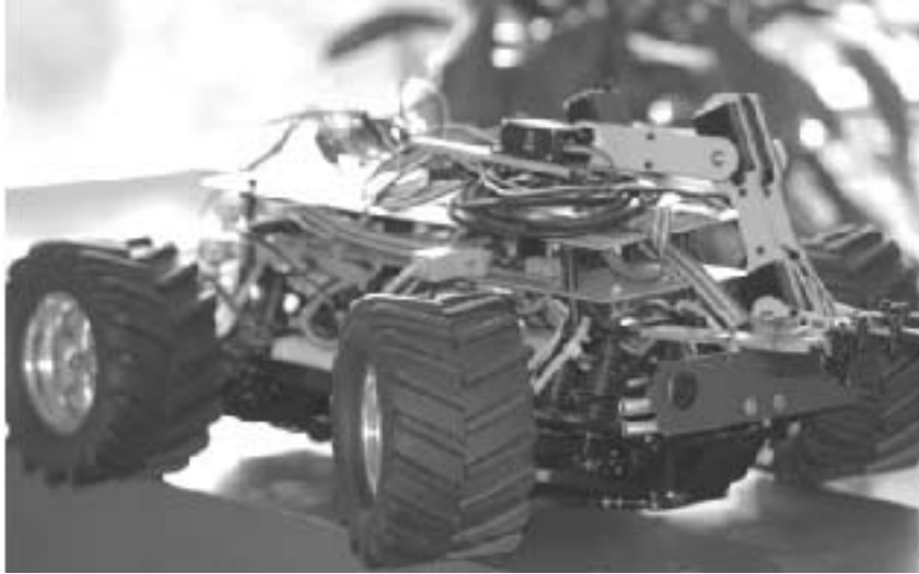
KUVA 10. Robotti-auto syksyllä 2006. Kuvassa näkyy mm. robotille tehty mekaaninen käsi sekä erilaisia robotin ohjaukseen liittyviä mikro-ohjaimia ja antureita (Vesa Torvinen)
