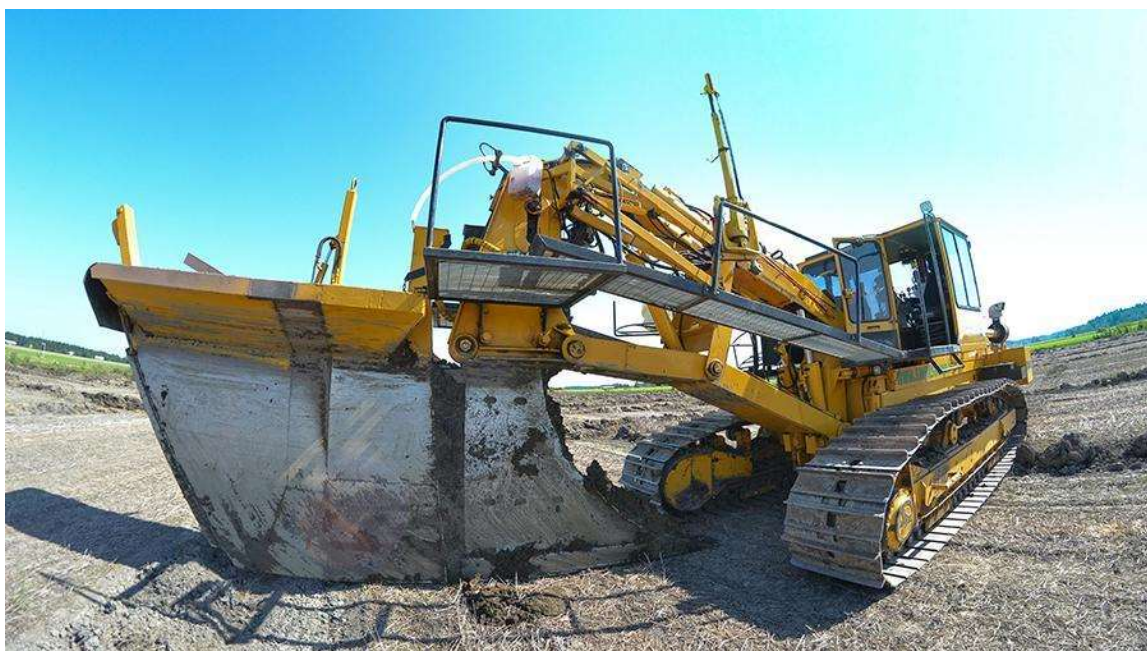
KUVA 2. Inter-Drain 2040 GP-aurakone (Savonsalaoja Oy julkaisuaika tuntematon)
