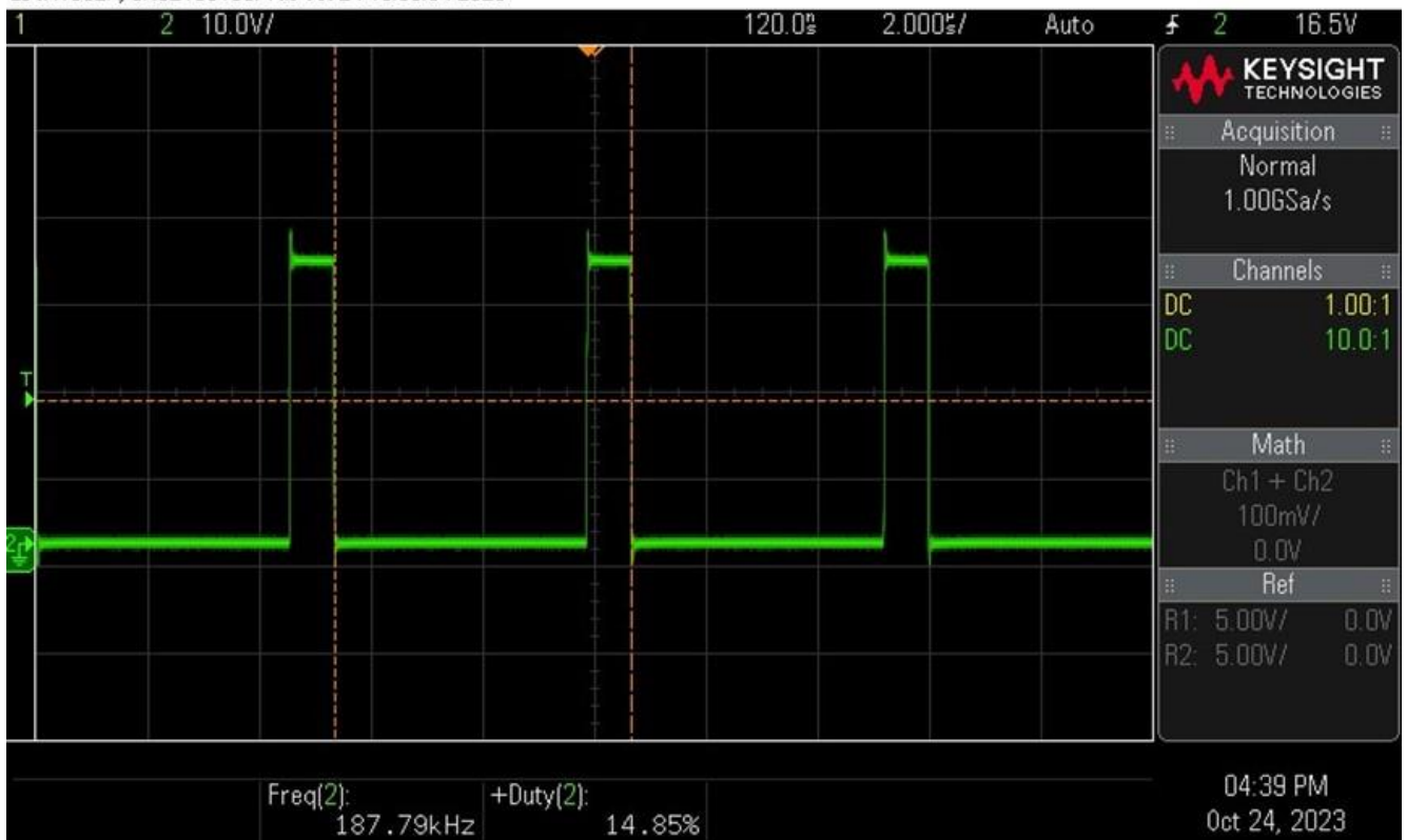
KUVA 15. Oskilloskoopin mittauskuva PWM-pulssista
