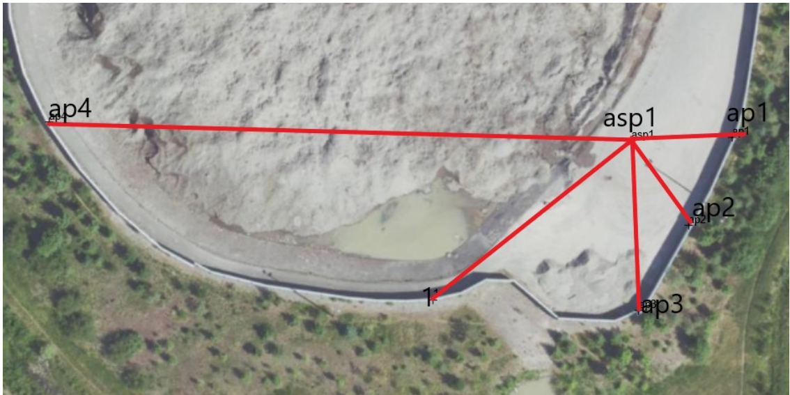
Kuva 10. Liitospisteiden ja kartoituspisteen sijainti asemapisteeseen nähden.
