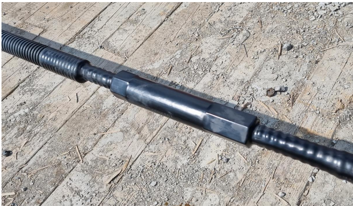
Kuva 3: Kallioankkurin korroosiosuojattu jatkos
