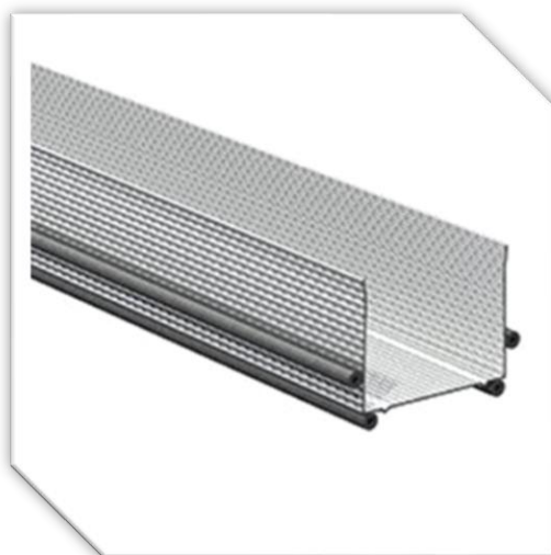
Kuva 10. Gyproc Oy:n Acounomic-kisko. Tiivisteet eristävät ääniaaltojen kulkua kiskon alitse. Kyljissä olevat tiivistenaumat estävät äänen tunkeutumista levyn alasaumasta rungon sisään (Gyproc.fi).
