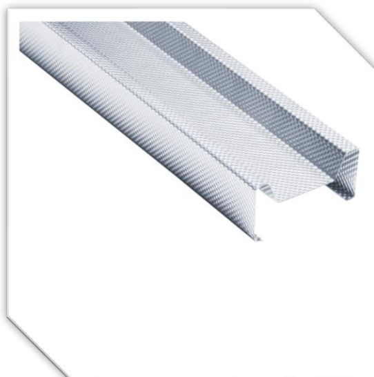
Kuva 7. Gyproc Oy:n XR-ääneneristysranka. Profiilin ansiosta ääniaalto kulkee rankaa pitkin suuremman matkaan ja vaimentaa näin ääniaaltoa (Gyproc.fi).
