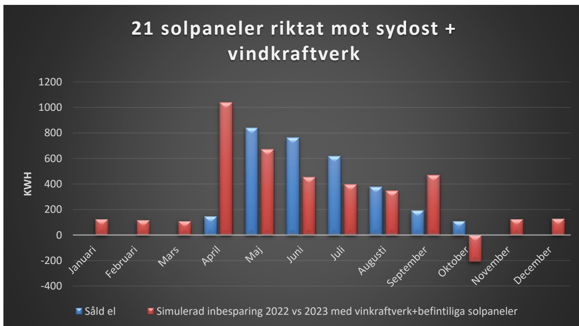
Figur 20: Graf över hur inbesparingen 2023 jämfört med 2022 hade sett ut med ett vindkraftverk och 21 solpaneler riktat mot sydost.
