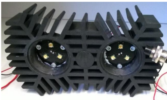
Kuva 7. Ruiskuvalettu lopputuote ilman linssejä.
