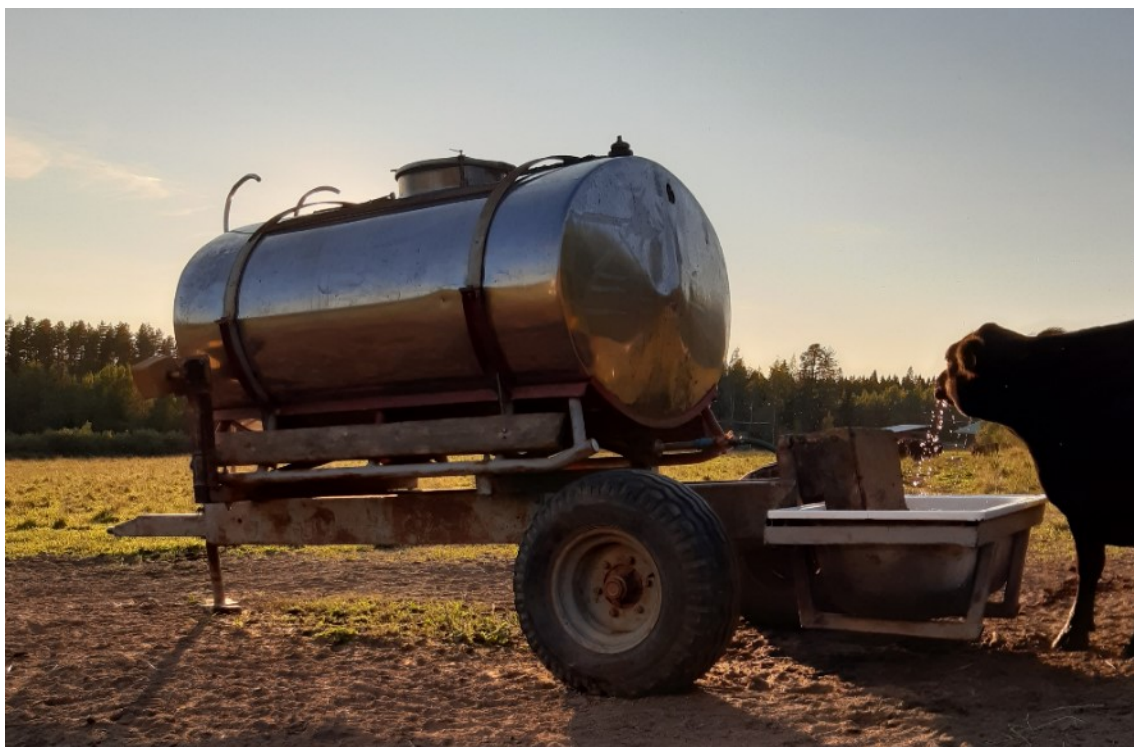
KUVA 17. Yksi Tila A:n vanhimmista ja suurimmista vaunuista, jossa säiliön tilavuus on 2500 litraa ja juottoaltaana on emaloitu kylpyamme (Huttunen 2021b).
