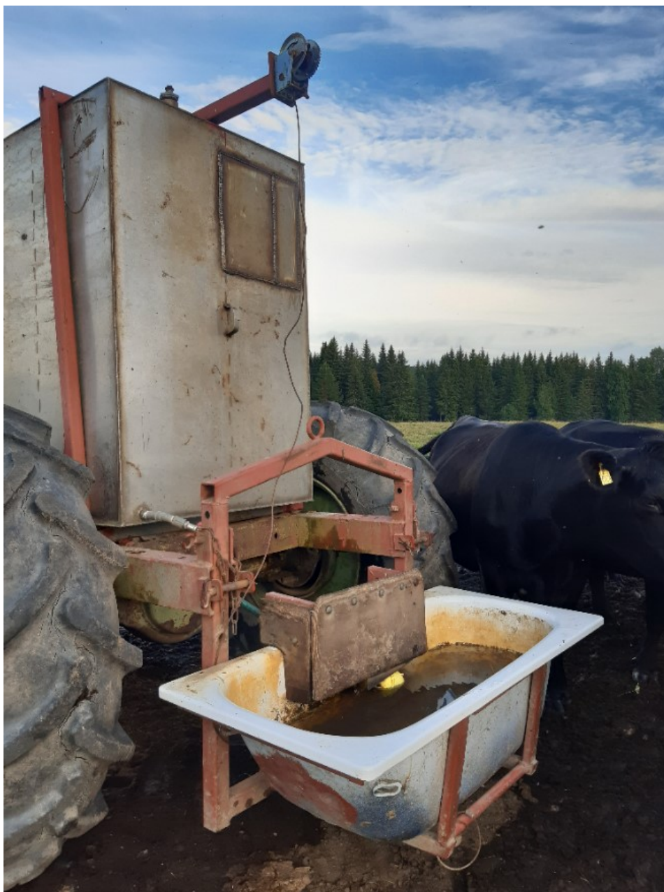
KUVA 26. Tila D:n juottovaunu, jossa on korkean maavaran vuoksi mahdollisuus vinsata juottoallas toiseen asentoon kuljetusta varten (Huttunen 2022r).
