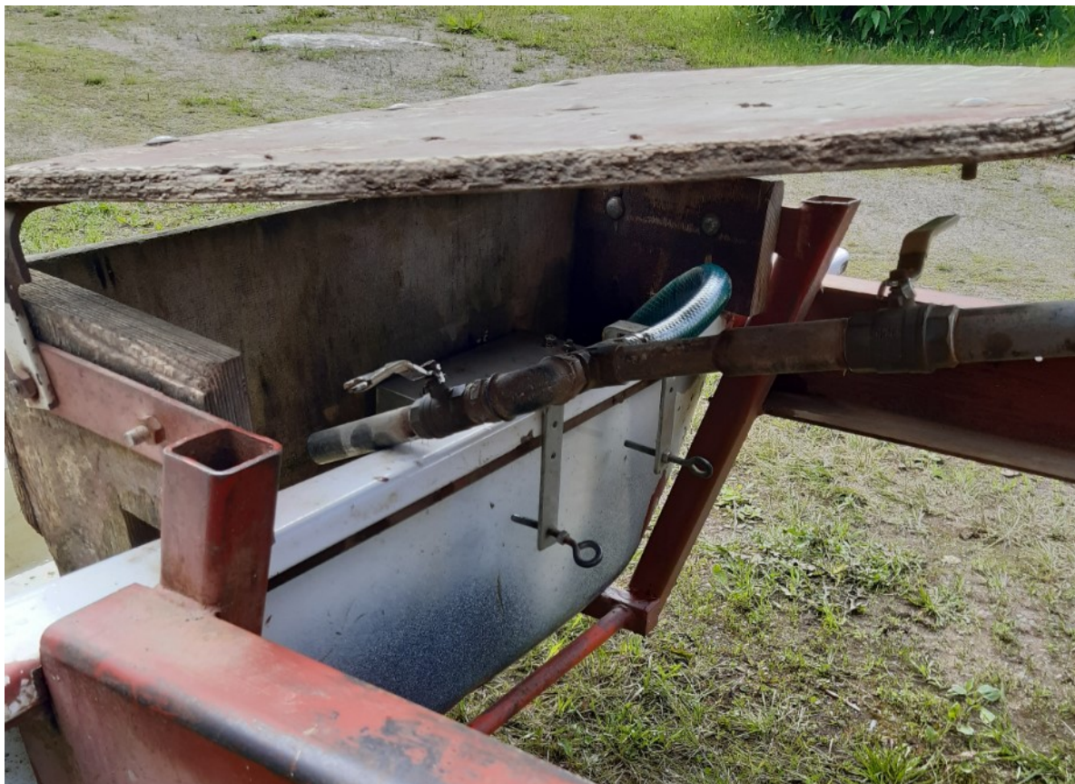
KUVA 10. Tila A:n juottovaunu, johon on rakennettu vanerista saranoitu suojustokotelo altaan uimurille ja hanoille (Huttunen 2022e).
