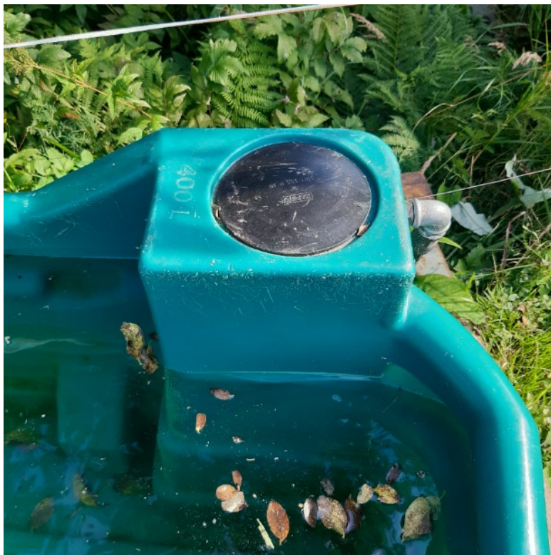
KUVA 16. Muovinen juottoallas, jossa on sisäänrakennettu uimuri (Huttunen 2022j).
