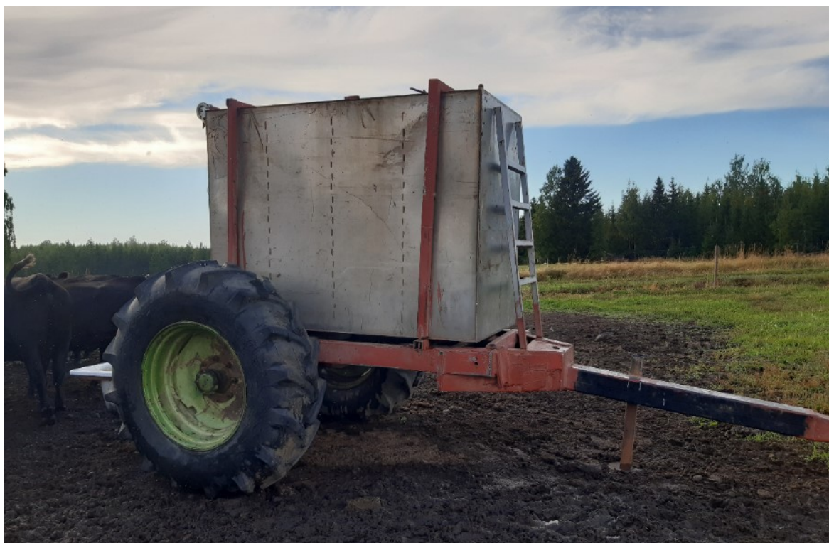
KUVA 27. Tila D:n juottovaunu, jonka toinen emotilallinen rakensi yrittäjille tilaustyönä (Huttunen 2022s).
