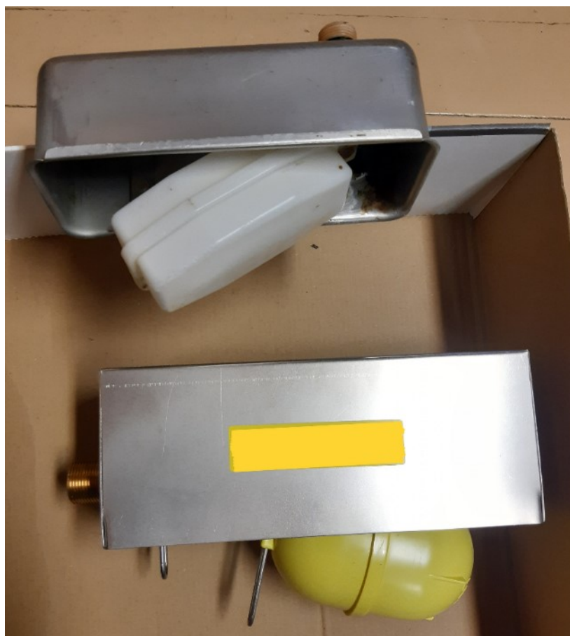
KUVA 15. Kaksi erilaista uimuria, joissa on vipuvarrella toimiva kelluke (Huttunen 2022i).
