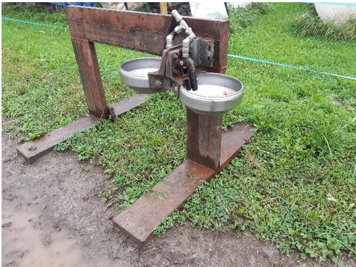
KUVA 14. Erään tilan omavalmisteinen juomapiste kahdella kupilla, joissa on turvalla painettavat venttiilit (Huttunen 2022h).
