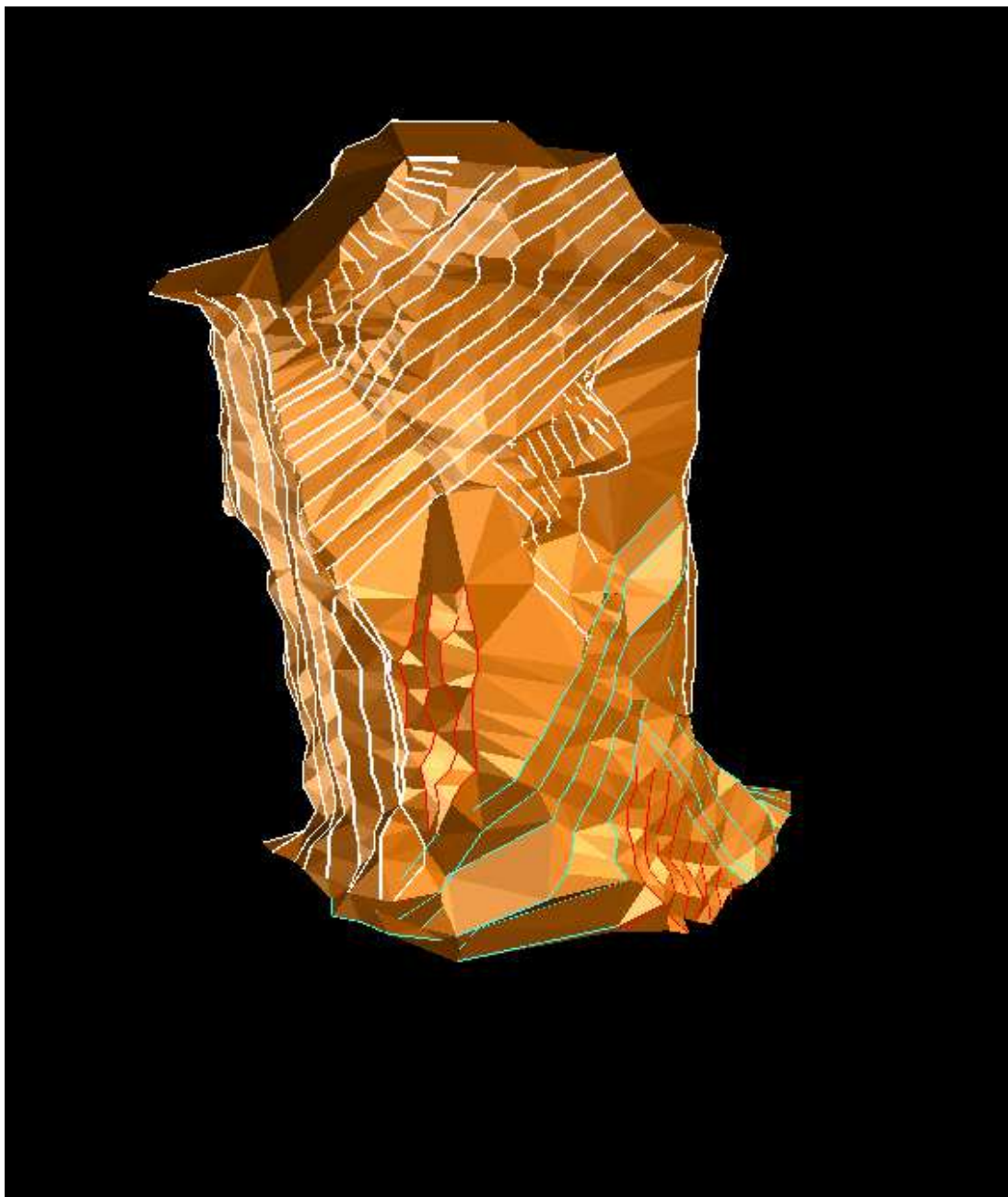
Kuvio 17. Kartoitettu louhos, josta on muodostettu kolmiulotteinen malli Surpacilla.
