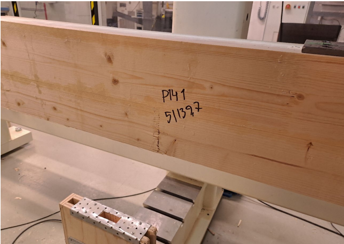
Kuva 12. Koekappale P14 1 (115mmx210mm) vaneripinta
