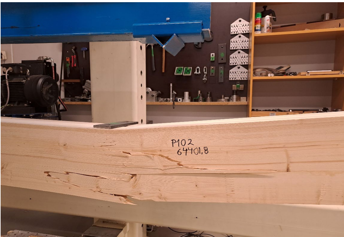
Kuva 3. Koekappale P10 2 (160mmx210mm) läpiliimattu
