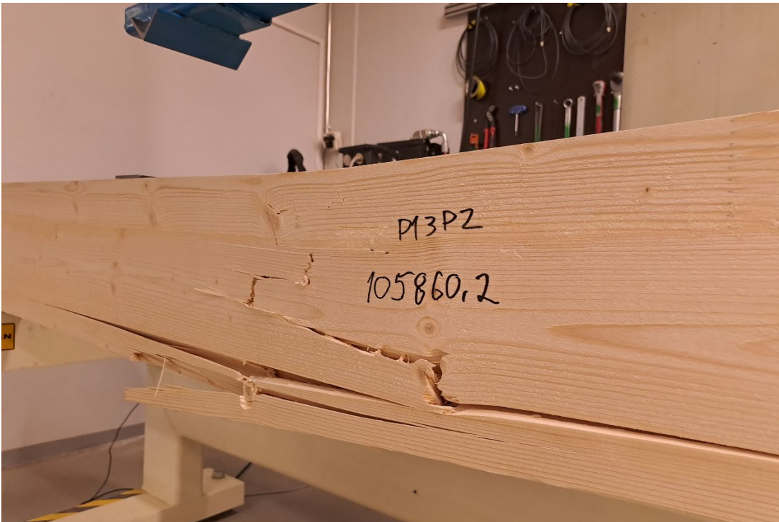
Kuva 8. Koekappale P13 P2 (240mmx210mm) pitkään suuntaan
