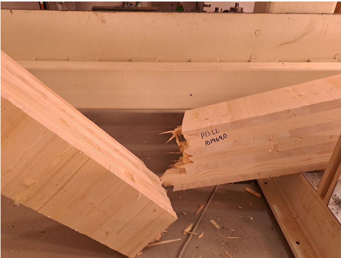
Kuva 11. Koekappale P13 L2 (240mmx210mm) lyhyeen suuntaan
