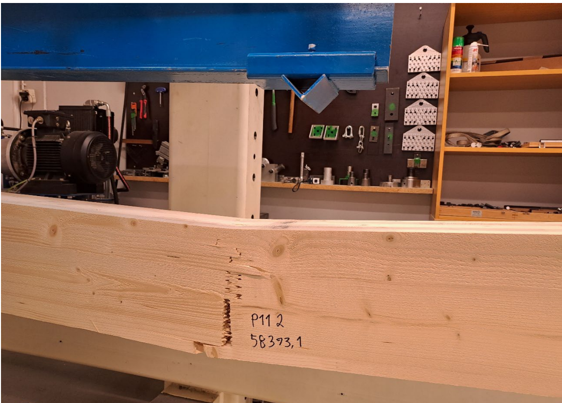
Kuva 5. Koekappale P11 2 (160mmx210mm) pitkään suuntaan
