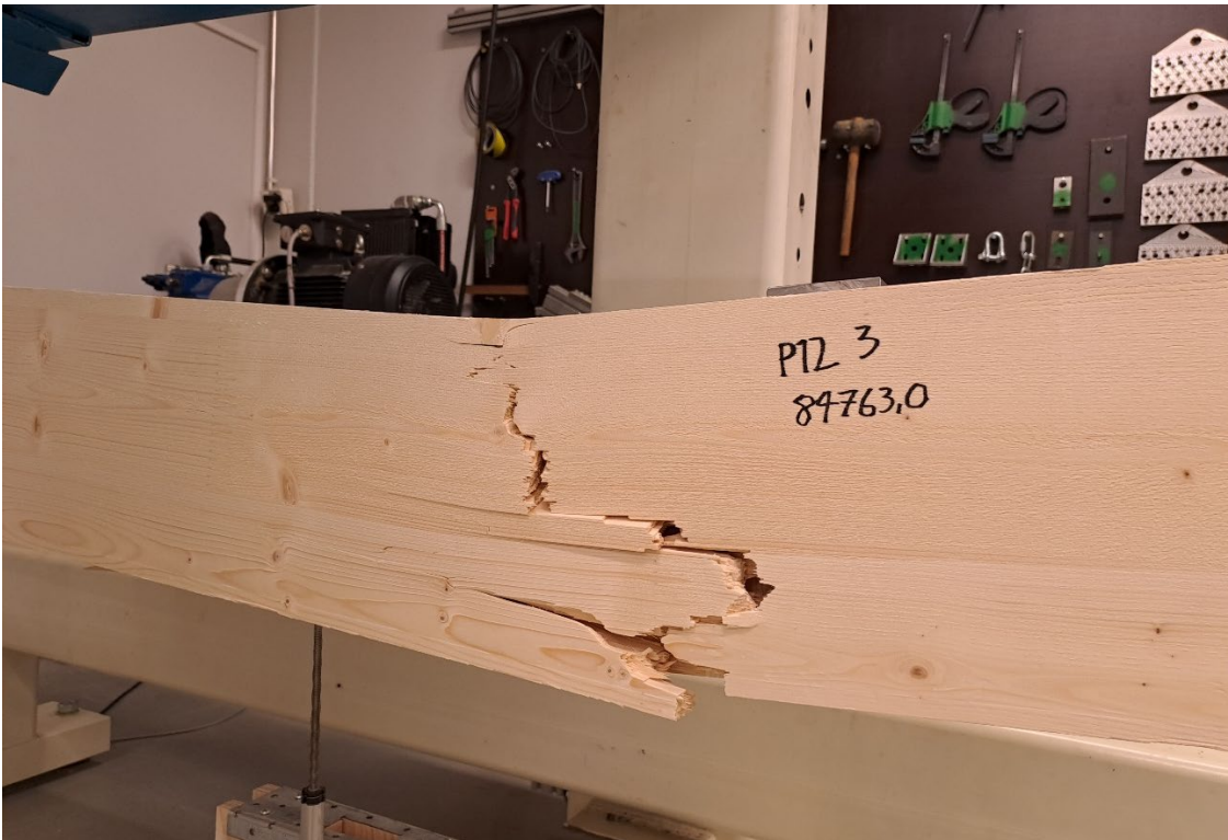
Kuva 6. Koekappale P12 3 (240mmx210mm) läpiliimattu
