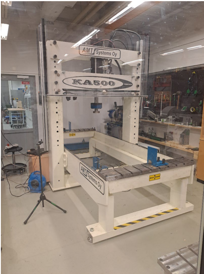
Kuva 1. Aineenkoestuslaite AMT Systems KA 500
