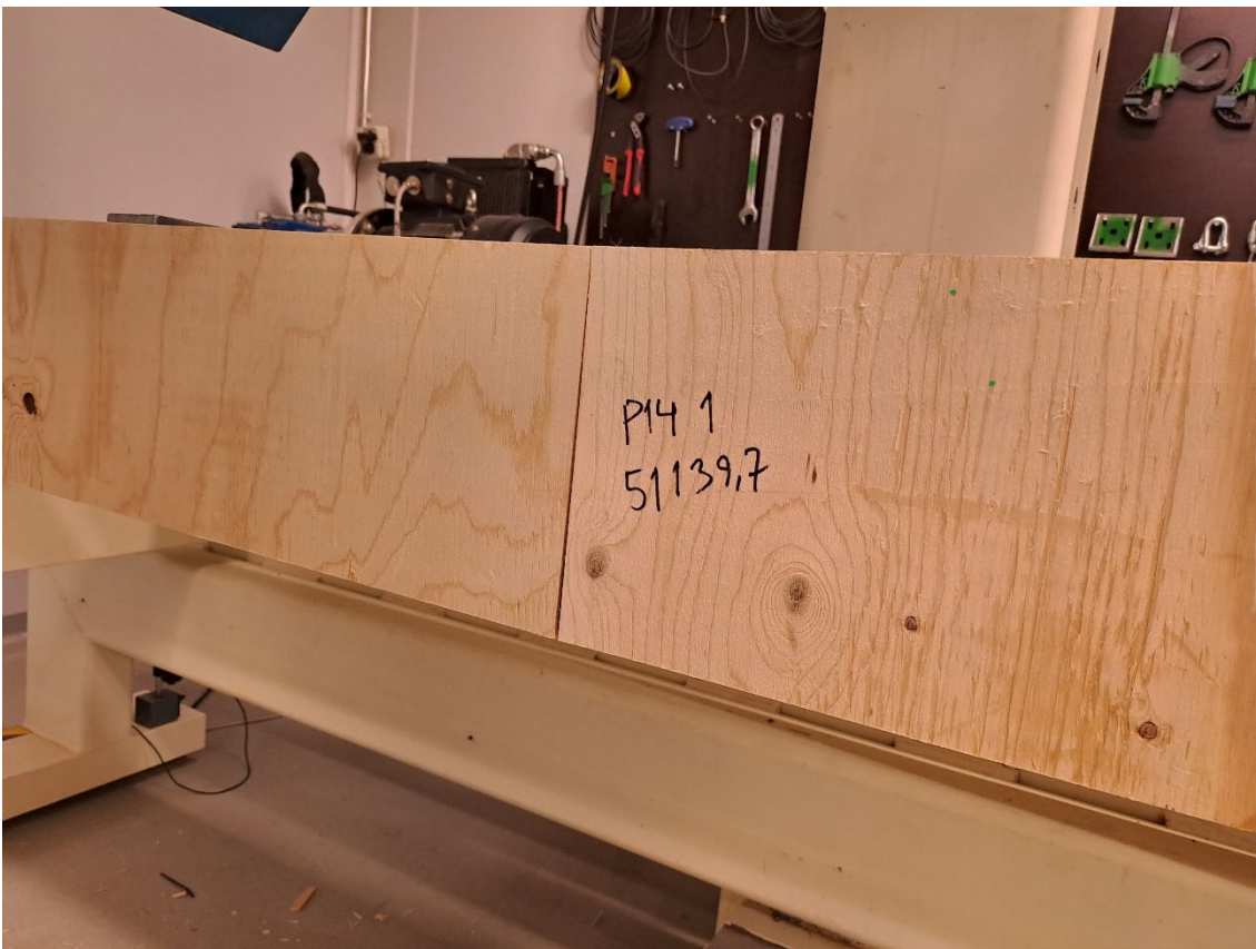
Kuva 13. Koekappale P14 1 (115mmx210mm) vaneripinta
