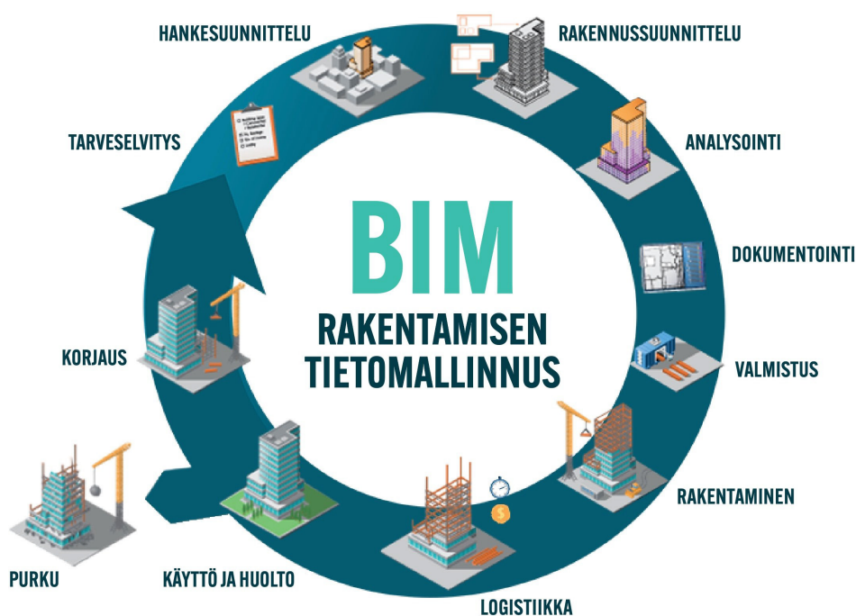
Kuva 2. Tietomallipohjaisen prosessin vaiheet. [11.]
