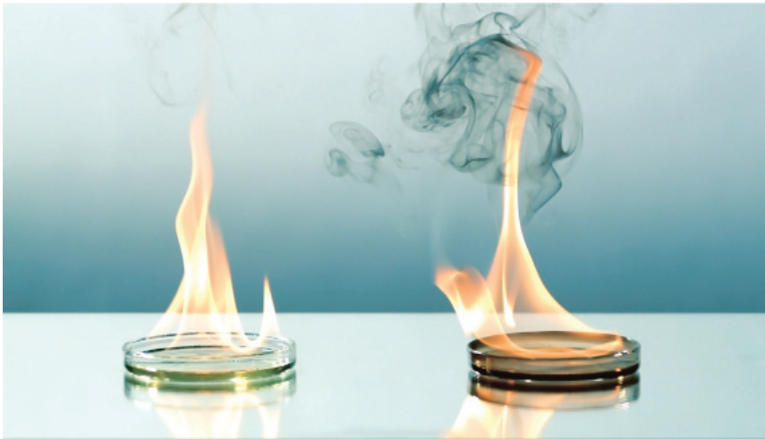
NEXBTL-polttoaine (vasemmalla) palaa silminnähden puhtaammin kuin fossiilinen diesel (Kuva: Neste Oil).
