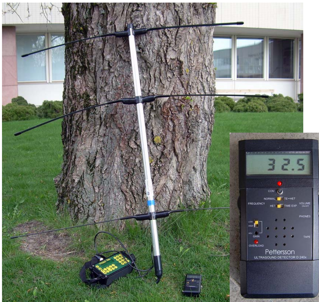
KUVA 5. Radioseurantaan tarvittavat vastaanotin ja antenni sekä ultraäänien kuuntelun mahdollista-va lepakkodekteri. © Emma Kosonen
