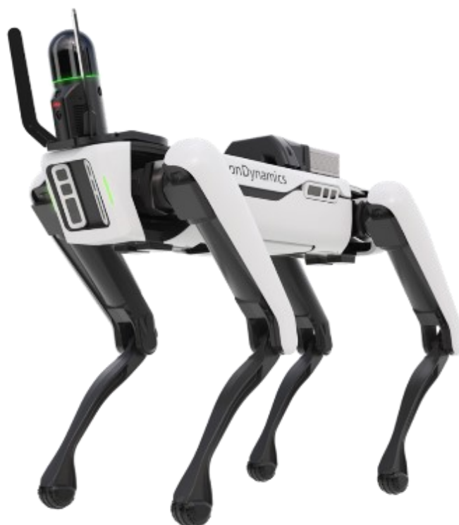
KUVA 2. Esimerkki robotti skannerista. Robotti on Boston Dynamicsin tekemä, johon on liitetty Leica ARC skanneri. Algoritmi saa kokoonpanon toimimaan yhdessä, jolloin robotti skannaa ennalta määritetyn reitin. (Leica Geosystems)
