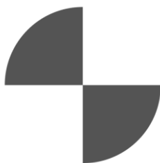
KUVA 17. Laserskannerin mustavalko tähys. (Vasara, 2023, CC BY-ND)
