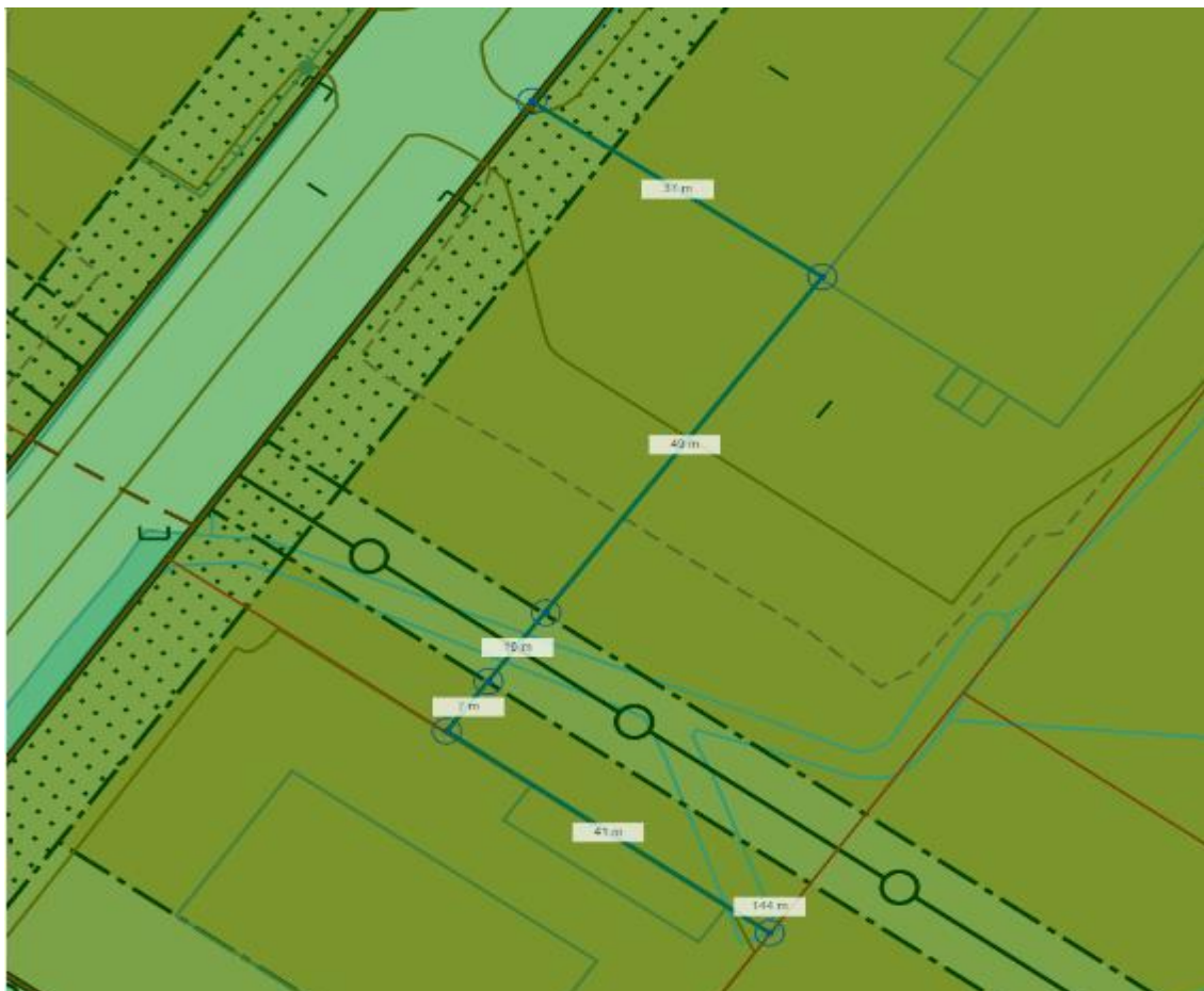
Kuva 6. Etäisyyksiä rajoihin sekä johtoaluevaraukseen rakennuksesta mitattuna asemakaavasta. (5)
