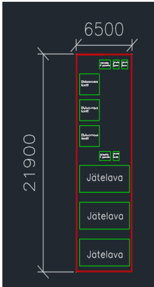
Kuva 13. Versio malli A:sta, jossa etukuormauskontit ovat sijoitettuna katoksen taakse.
