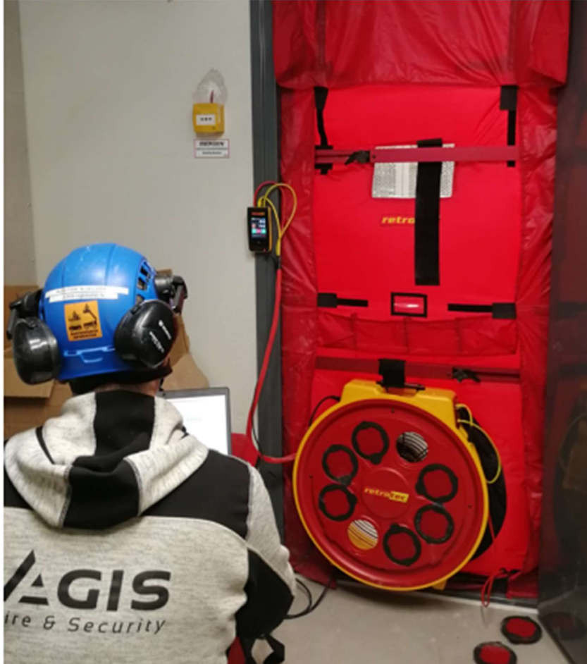
Kuvio 8. AGIS Fire & Securityn työntekijä suorittamassa tilatiiveyskokeita (AGIS Fire & Security Oy 2023)
