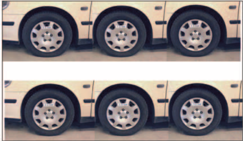
Kuva 8.5 Havainnollistus vajaan rengaspaineen visuaalisen havainnoinnin vaikeudesta. Rengaspaineet vasemmalta oikealle ylärivissä välillä 0.5–1.5 bar ja alarivissä välillä 2.0–3.0 bar 0.5 barin portain.
