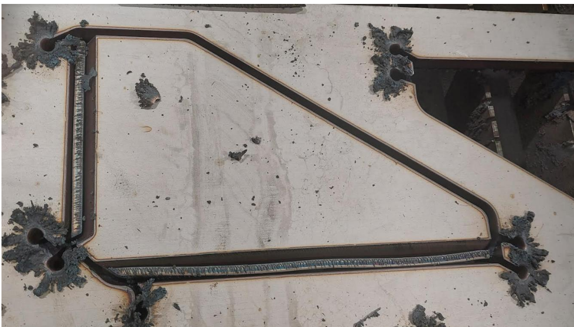
Kuva 2. 16 mm paksuisesta ruostumattomasta teräksestä plasmaleikkauksella tehty viistekappale.
