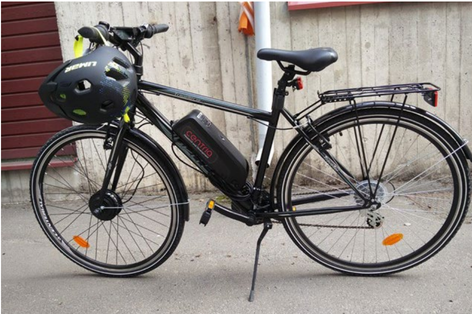
KUVA 2. DUDE-osallistajat muunsivat tavallisen polkupyörän sähköpyöräksi.
